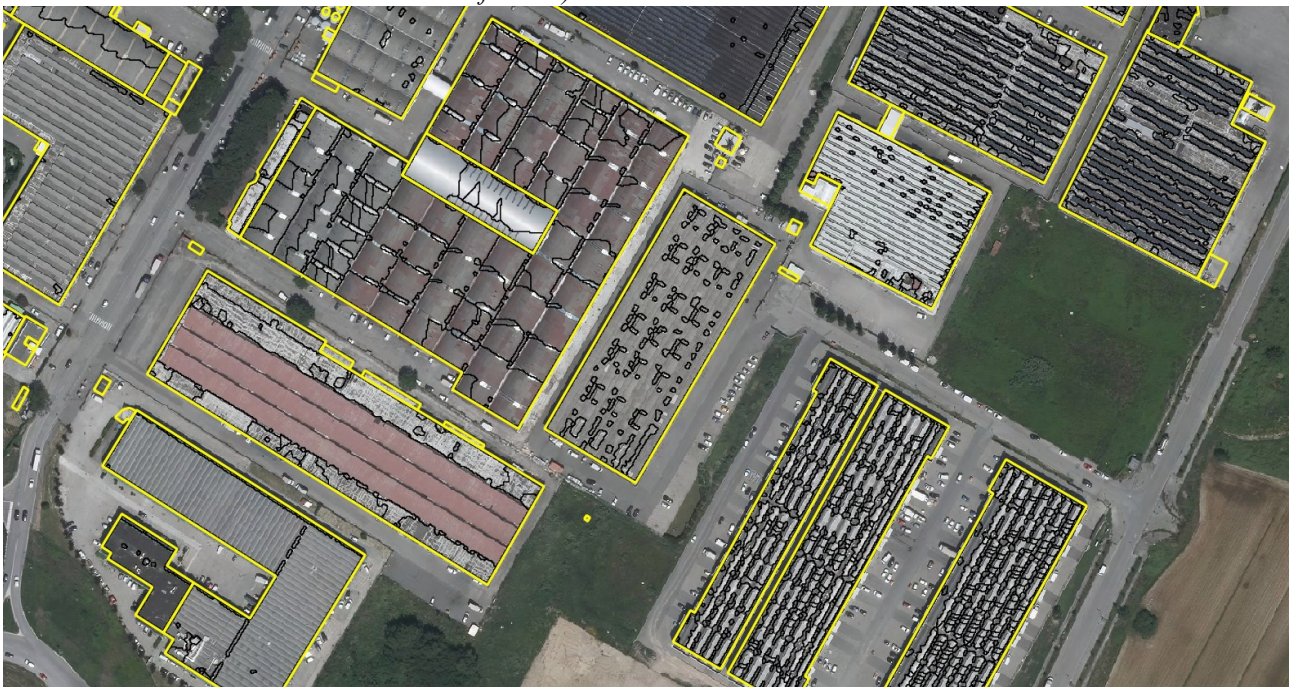
Figura App. 3 - Capannoni industriali con coperture estratte dalla CTR (Stessa immagine precedente con il risultato della classificazione ad oggetti, si noti come il capannone che presentava due colorazioni è stato individuato dal classificatore)
