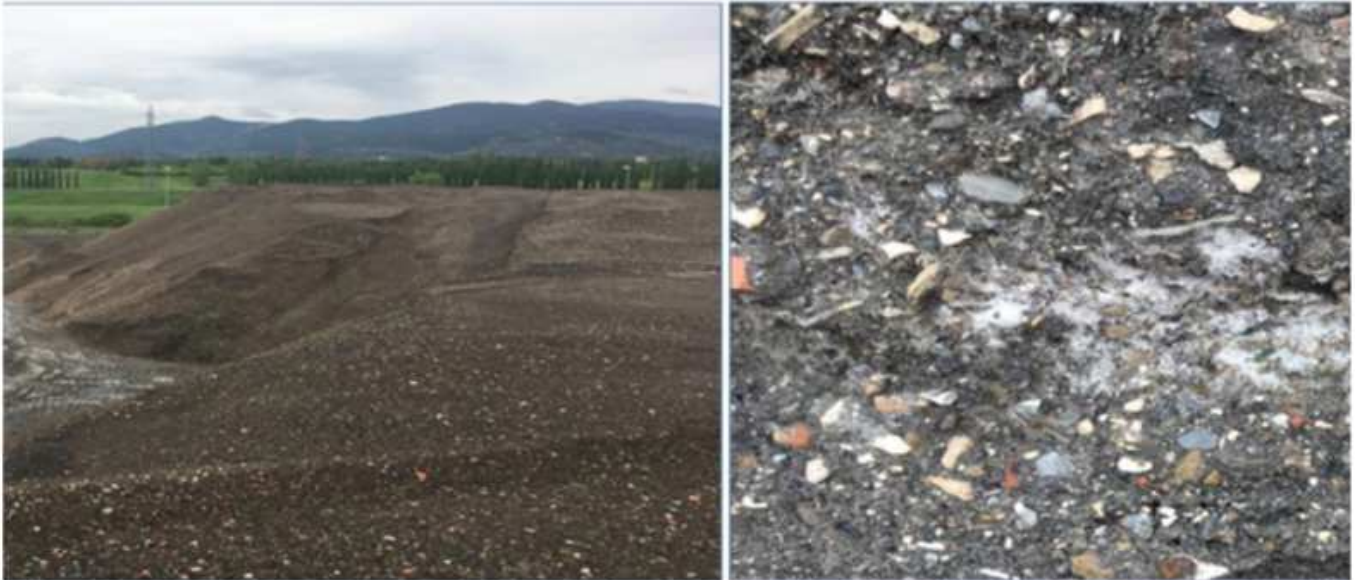
Cumuli di materiale riciclato in attesa di commercializzazione presso l'impianto LE ROSE e dettaglio della consistenza granulometria della frazione denominata 0-30 fine
