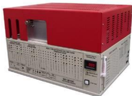
Fig. 3.7 - GC SRI 8610C con dettaglio della configurazione dei sensori utilizzati
