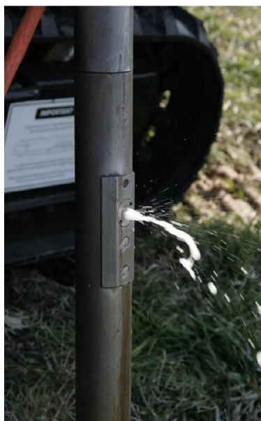
Fig. 3.4 – Flusso di acqua attraverso la membrana rimovibile in acciaio
