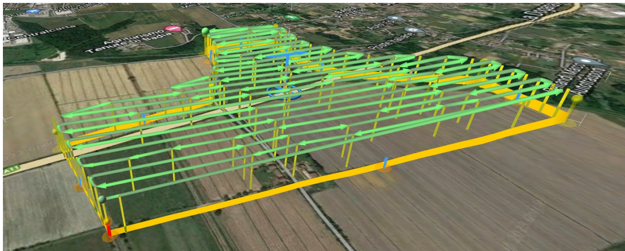
Figura 7. Esempio di missioni di volo programmate per il rilievo dell'area indagata
