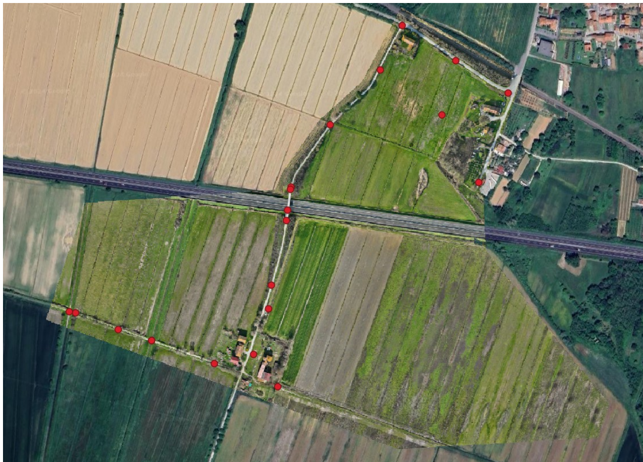
Figura 5. Posizionamento dei punti di appoggio dell'elaborazione fotogrammetrica
