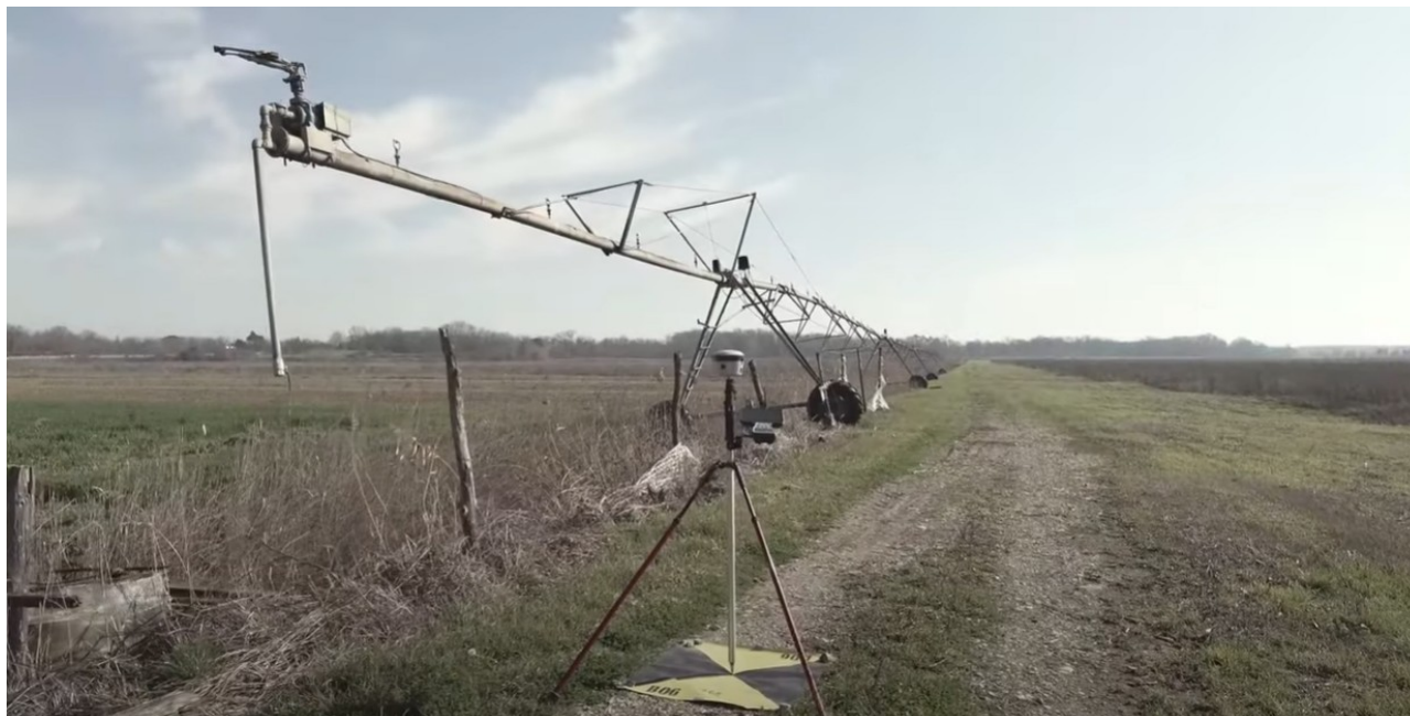
Figura 6. Misura delle coordinate di un punto di appoggio con antenna GNSS
