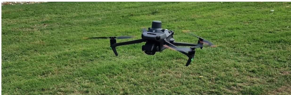
Figura 3. UAV (drone) impiegato nelle operazioni di sorvolo e presa aerofotogrammetrica
