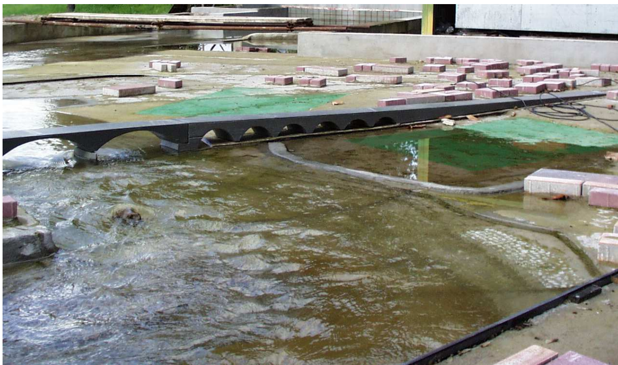
Fig. 5.10: Modello fisico del fiume Arno a Incisa
