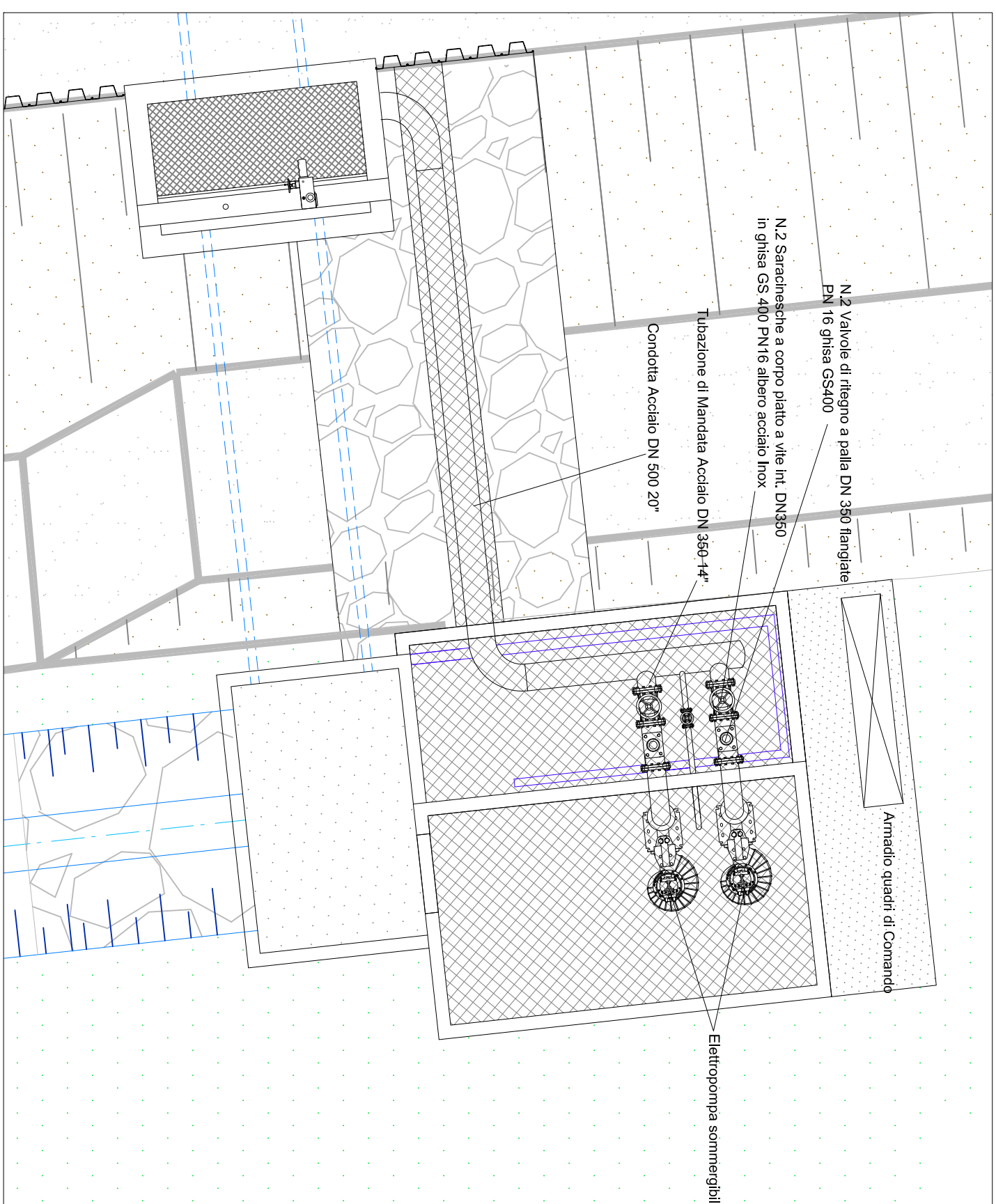
Particolare scarico Casa Nuova dell'Arno - Impianto di Sollevamento-Scala 1:100 -
