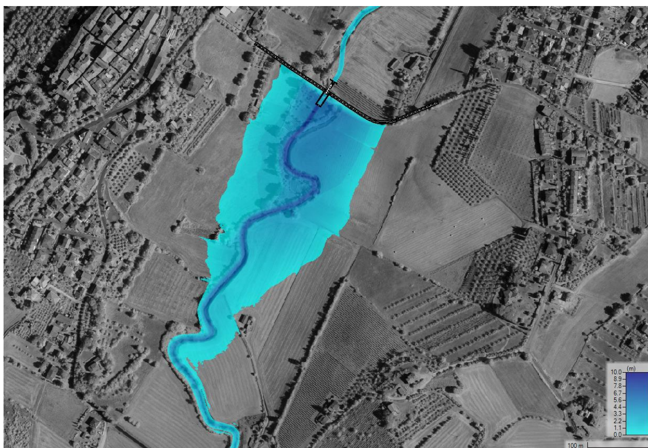
Figura 4-1: vista 3D dell'istante di massimo riempimento dell'invaso durante l'evento di piena critica TR200 (d=4 h)
