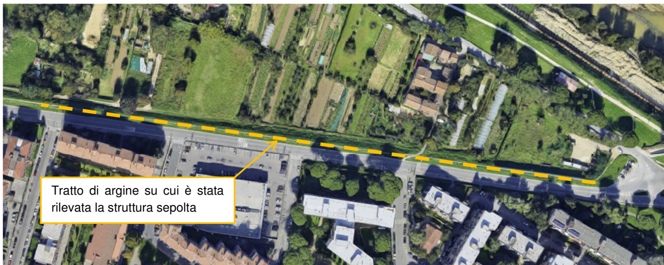
FIGURA 6. TRATTO DI ARGINGROSSO ALL'INTERNO DEL QUALE È STATA RILEVATA UNA STRUTTURA SEPOLTA
