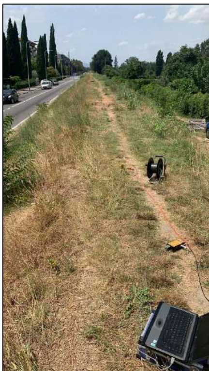
Foto – Indagine sismica attiva MASW
