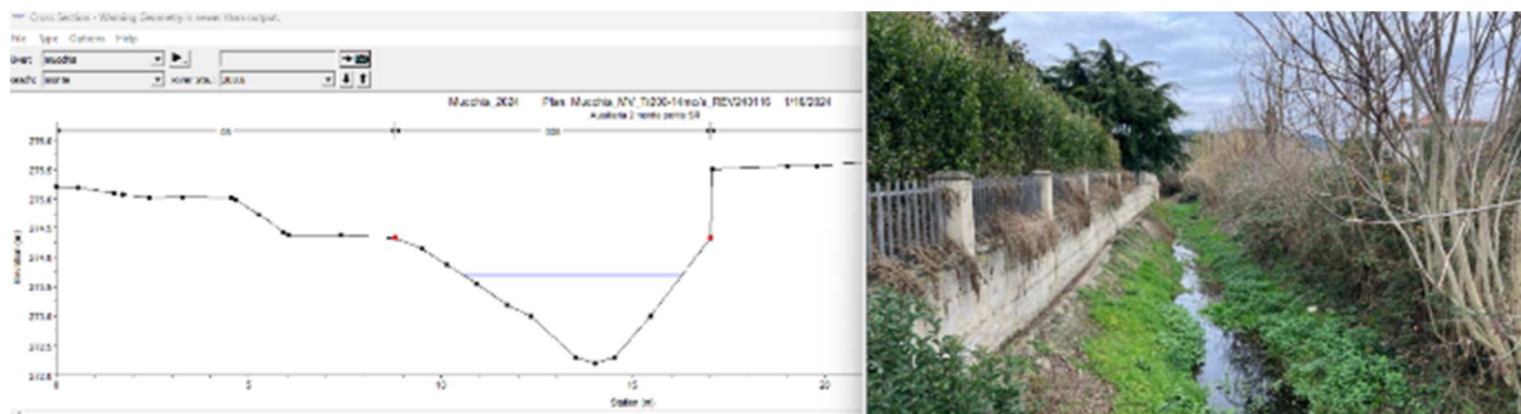
FIGURA 15 – SEZIONE D'ALVEO A MONTE DELLA STRADA REGIONALE 71 "UMBRO-CASENTINESE" (VISTA DA MONTE) E FOTO TRATTO OGGETTO DI APPROFONDIMENTO (FOTO VISTA DA VALLE)
