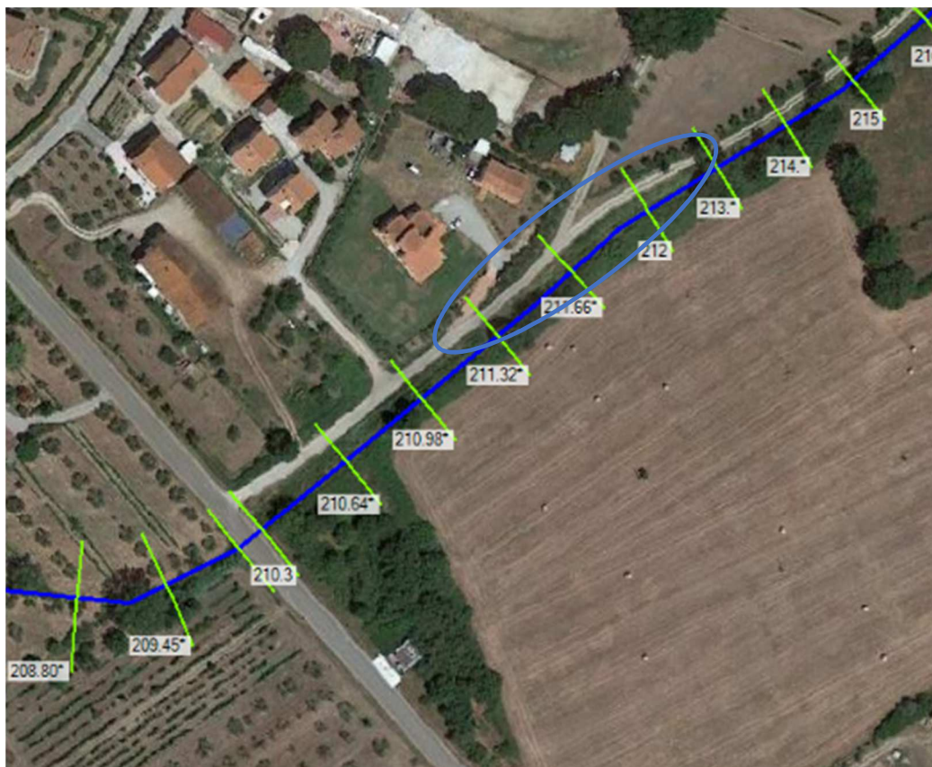
FIGURA 20 – LOCALIZZAZIONE ZONA A RISCHIO ESONDATIONE A MONTE DEL PONTE DELLA STRADA PROVINCIALE N. 75/BIS "DEL TRASIMENO"
