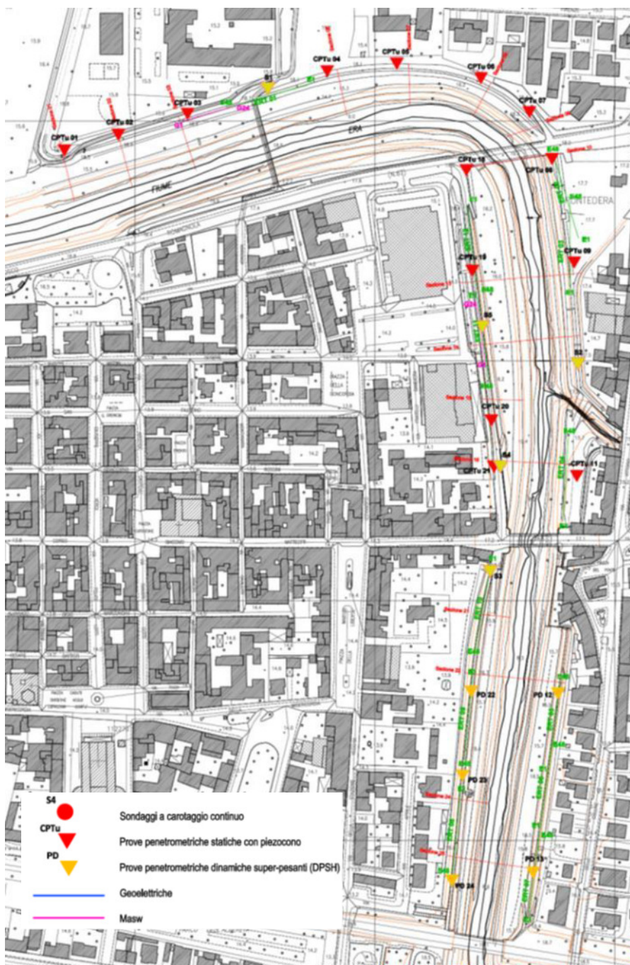
Figura 6-3 - Sx, Sondaggio a carotaggio continuo; CPTu, Prove penetrometriche statiche con piezocono; Pdx, Prove penetrometriche dinamiche. In rosa le stese sismiche MASW ed in Blu le stese geoelettriche.
