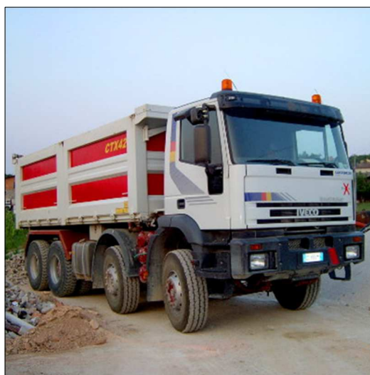
Figura 5-2: Tipologico autocarro stradale da utilizzare sul tratto 1 del percorso 2 - volume cassone 18-20m 3 , portata 40t
