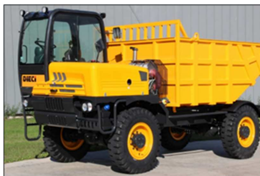
Figura 5-3: Tipologico dumper da cantiere da utilizzare sul tratto 2 del percorso 2 - volume cassone 6,5m 3 , portata 12.000kg
