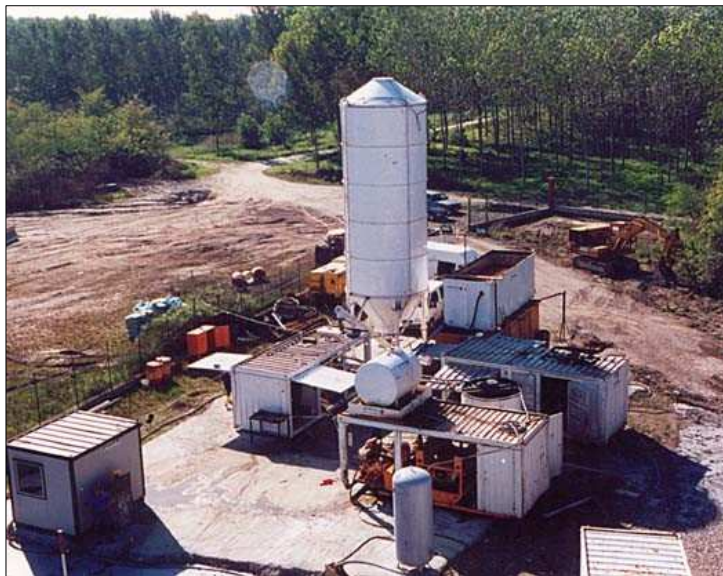
Figura7-11 Tipico area d'impianto per jet grouting.
