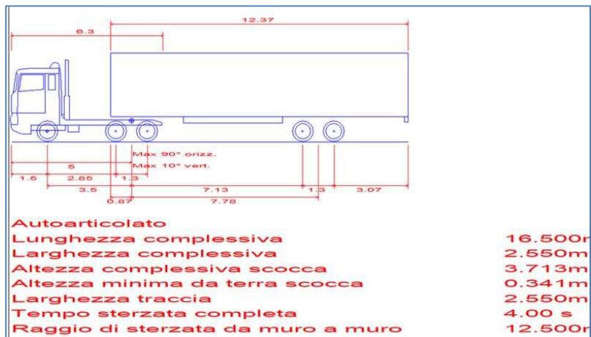
Figura 7-6 Convoglio utilizzato per la verifica di trasporto della sonda HH300 e MASS 6000
