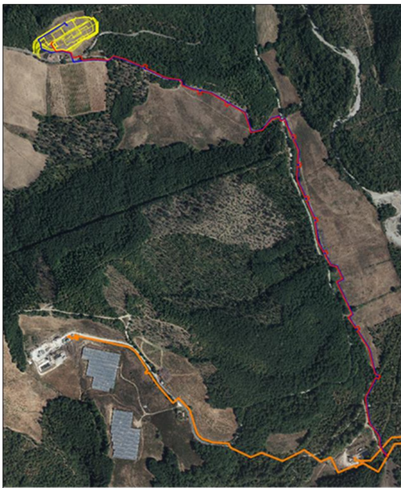
Figura 5-12: Radicondoli_36 - Opere a Rete – In arancione rete fluidi esistente; in rosso nuovo tratto di vapordotto/bifasedotto; in blu nuovo tratto di acquedotto (sia quello di perforazione che quello dedicato al lavaggio del vapore).
