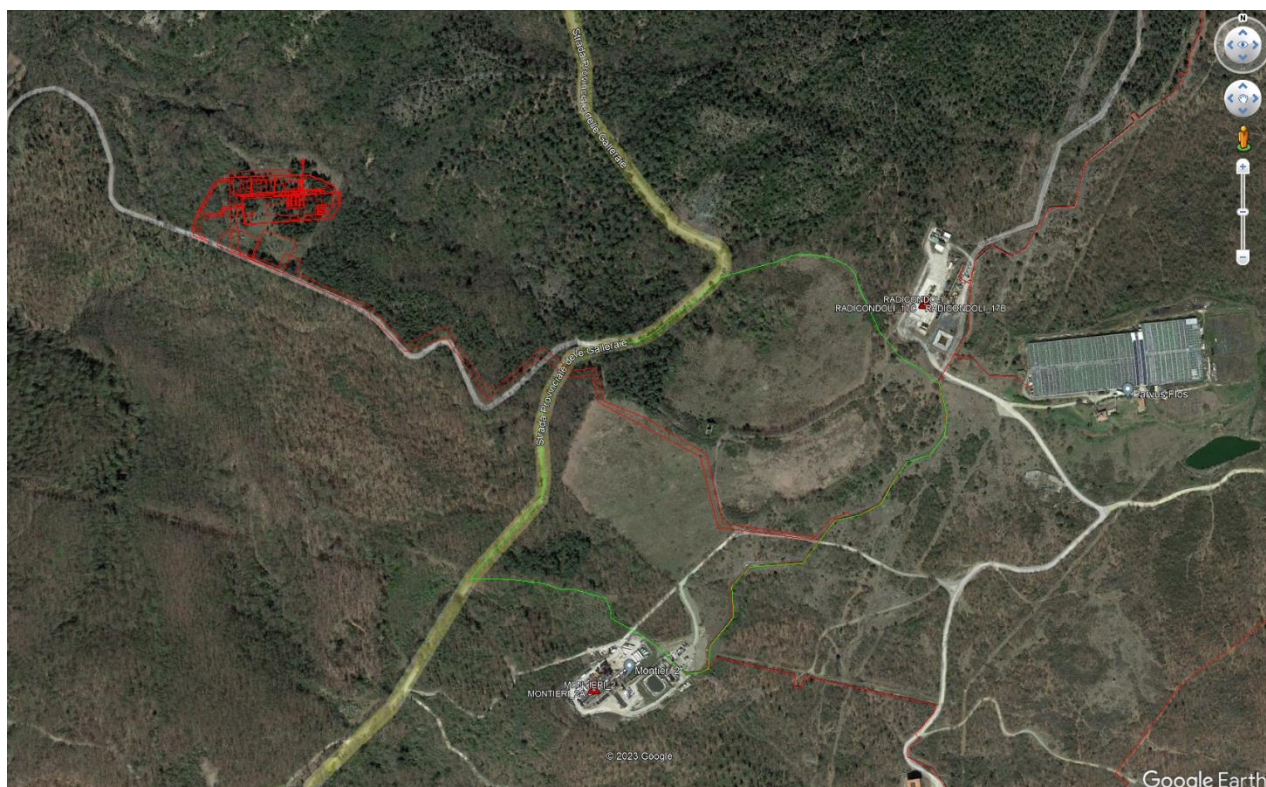
Figura 8-2: Postazione Radicondoli_35 e relativo percorso nuove linee fluidi (in verde il perimetro della Riserva Palazzo; in rosso la postazione il nuovo tracciato delle linee fluidi)
