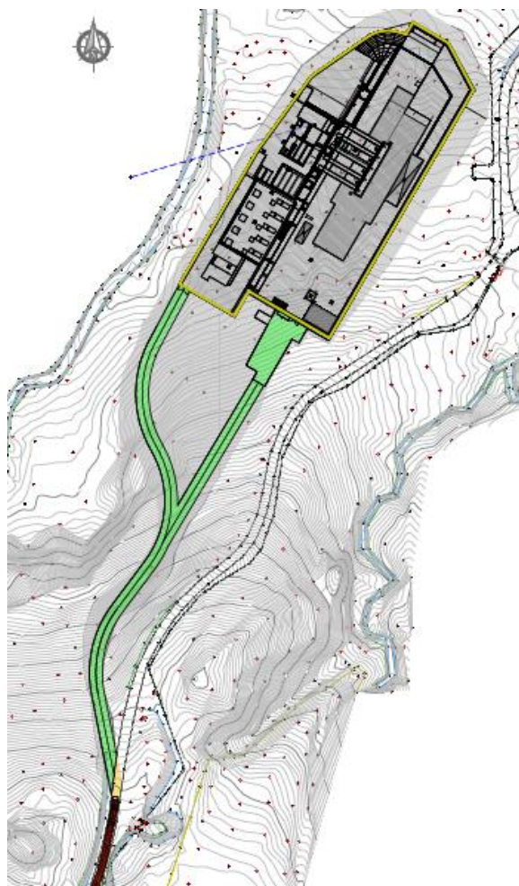
Figura 5-21: Particolare modifica viabilità pubblica (in giallo) tramite le bretelle di accesso (in verde) alla postazione Montieri_7 (in grigio)
