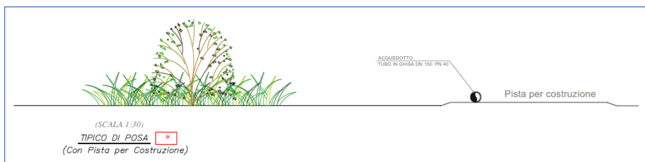
Figura 5-14: Tipico posa acquedotto (caso con pista di costruzione)
