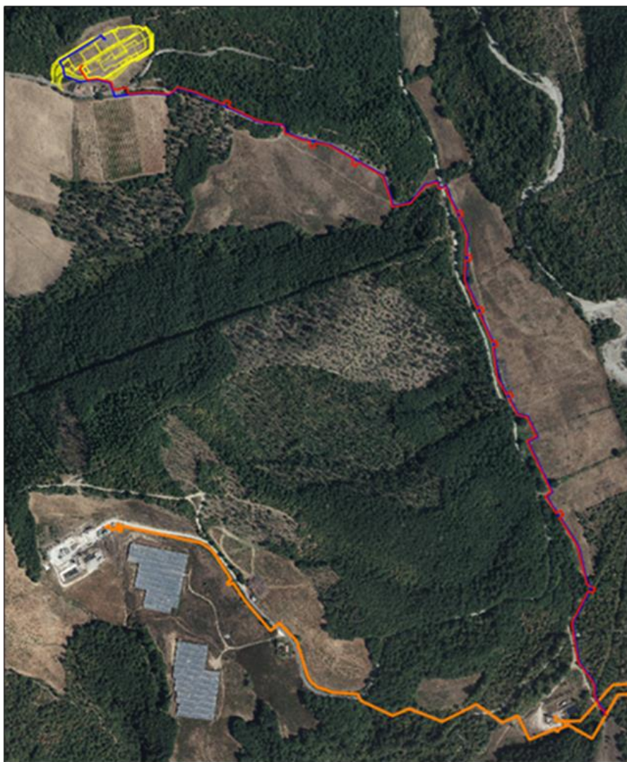
Figura 2-3: Radicondoli_36 - Opere a Rete – In arancione rete fluidi esistente; in rosso nuovo tratto di vapordotto/bifasedotto; in blu nuovo tratto di acquedotto (sia quello di perforazione che quello dedicato al lavaggio del vapore).
