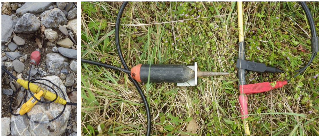
Figura 9: geofono per onde P (verticale, a sinistra) e per onde S (orizzontale, a destra)
