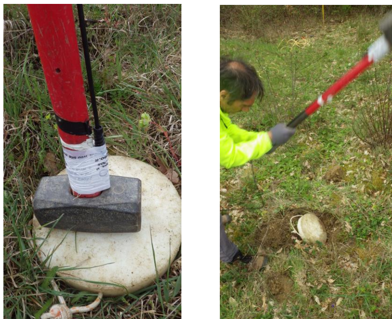
Figura 10: Linea L1, energizzazione tramite mazza strumentata
