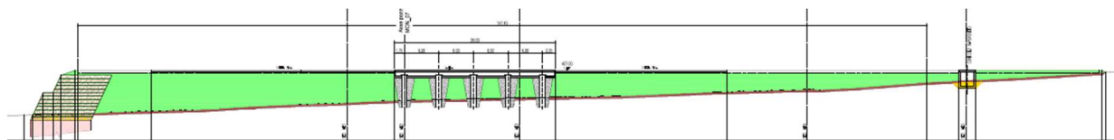
Figura 2 - Sezione longitudinale della piazzola con evidenza del rilevato artificiale (in colore verde) e delle terre rinforzate (a sinistra) con trattamento jet-grouting alla base (da elaborato di progetto GRE.EEC.D28.IT.G.13405.00.034).
