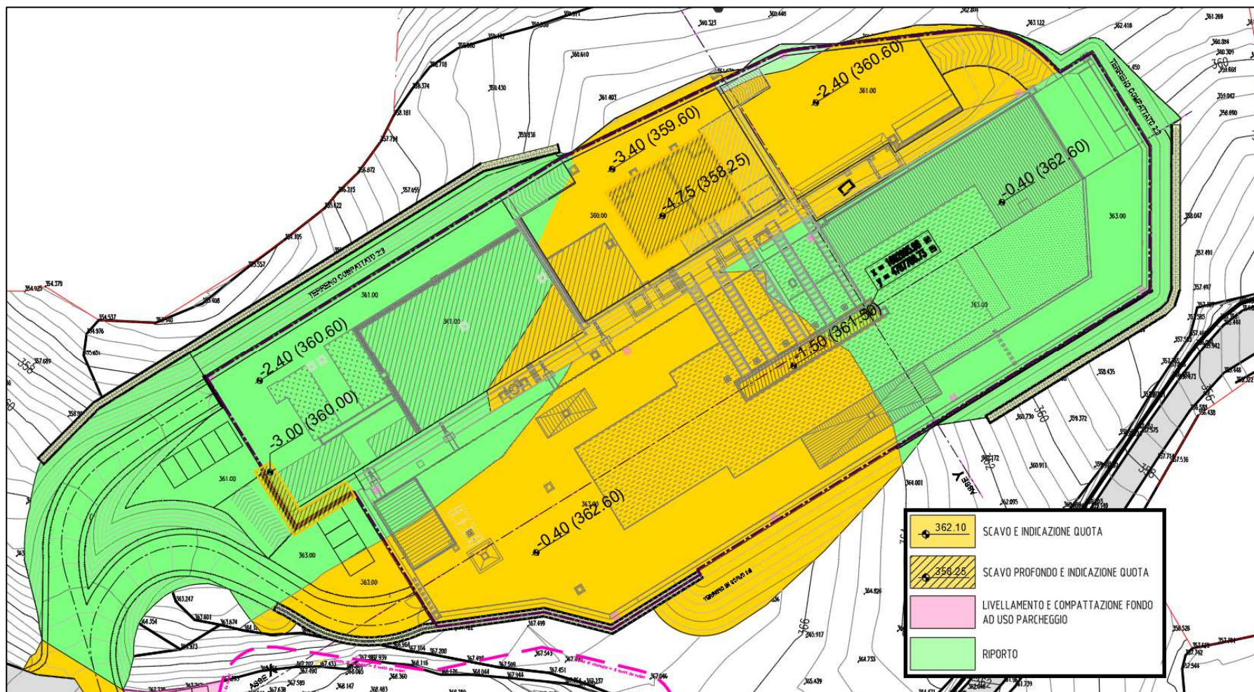
Figura 4-6 Planimetria scavi e riporti (con relativa legenda) - Stralcio della tavola R36040_PScRi. In arancio sono indicati gli scavi, mentre in verde sono indicati i riporti. Gli scavi più profondi sono relativi a: vasche reflui -4.75 m, cantina dei pozzi -1.5 m e fondazione muro di sostegno -3.0 m.
