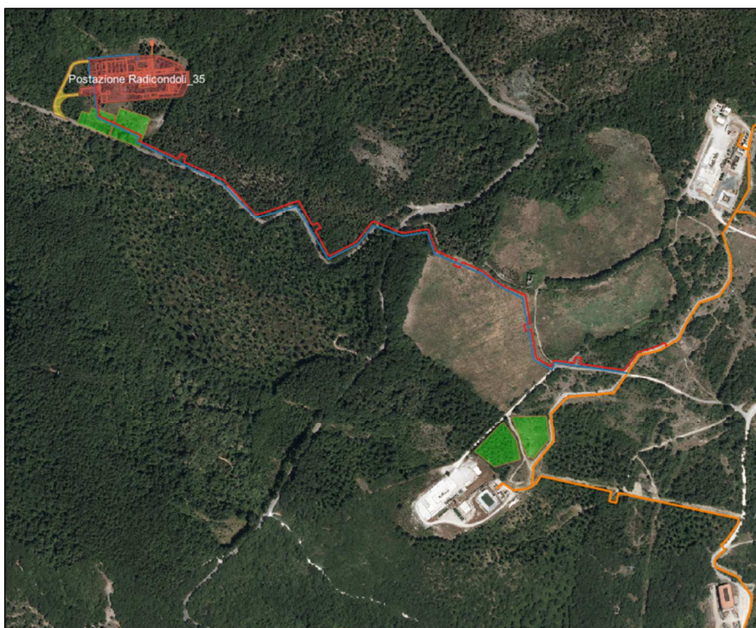
Figura 4-4 Planimetria dell'impianto con gli allacciamenti della rete fluidi. In arancione rete fluidi esistente; in rosso nuovo tratto di vaporedotto/bifasedotto; in blu nuovo tratto di acquedotto. A sud-est è visibile la Postazione Montieri 2, a nord-est è invece visibile la Postazione Radicondoli 17.
