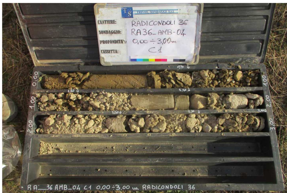
Figura 5-9: Sondaggio ambientale RA36_AMB_04 eseguito nell' area della postazione.
