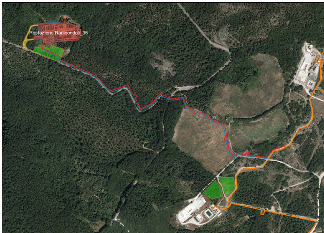
Figura 3-2 Planimetria dell'impianto con gli allacciamenti della rete fluidi. In rosso il nuovo tratto di vaporedotto/bifasedotto; in blu nuovo tratto di acquedotto. In verde le aree di cantiere.
