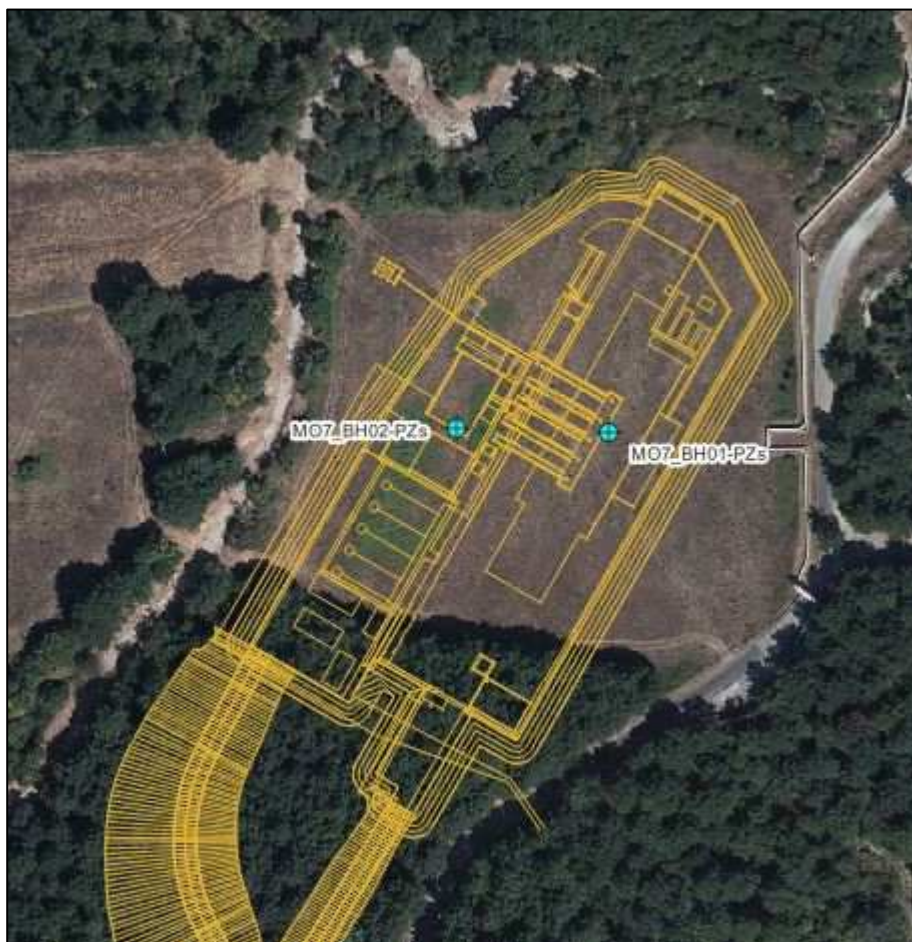
Figura 6-3: Piano indagini geognostiche. Planimetria con indicati in color ciano i piezometri superficiali.
