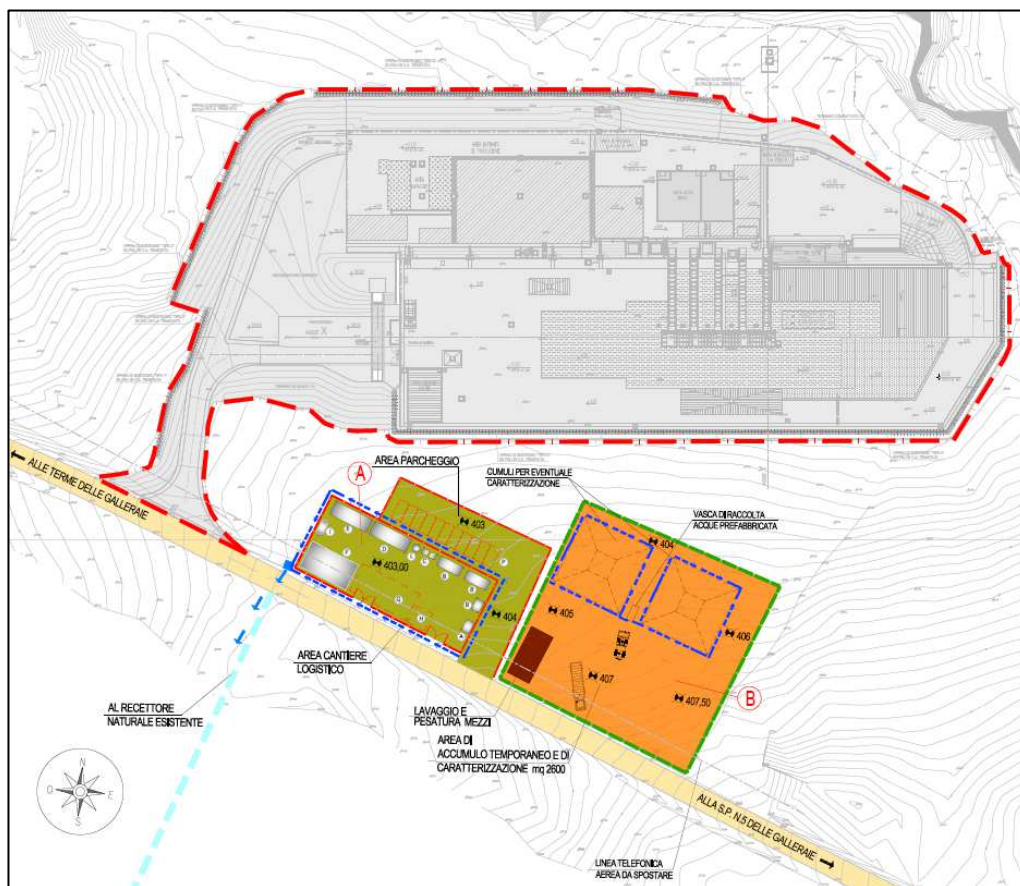
Figura 4-5 Planimetria e pianta cantiere civile - Stralcio della tavola R35045_Pcant.
