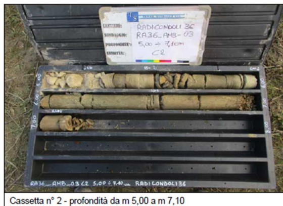
Figura 5-8: Sondaggio ambientale RA36_AMB_03 eseguito nell' area della postazione.
