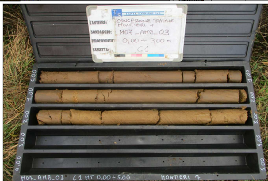
Figura 5-8: Sondaggio ambientale M07_AMB_03, eseguito nell'area della postazione.
