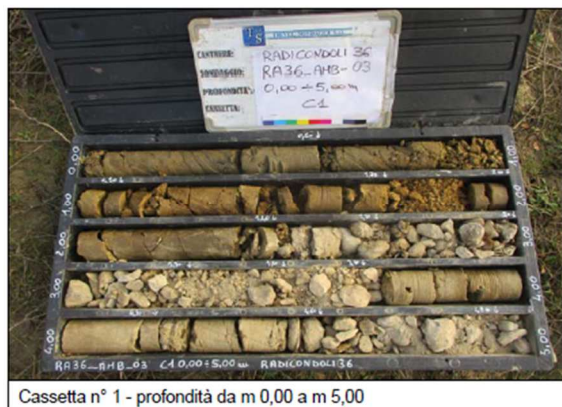
Figura 5-8: Sondaggio ambientale RA36_AMB_03 eseguito nell' area della postazione.
