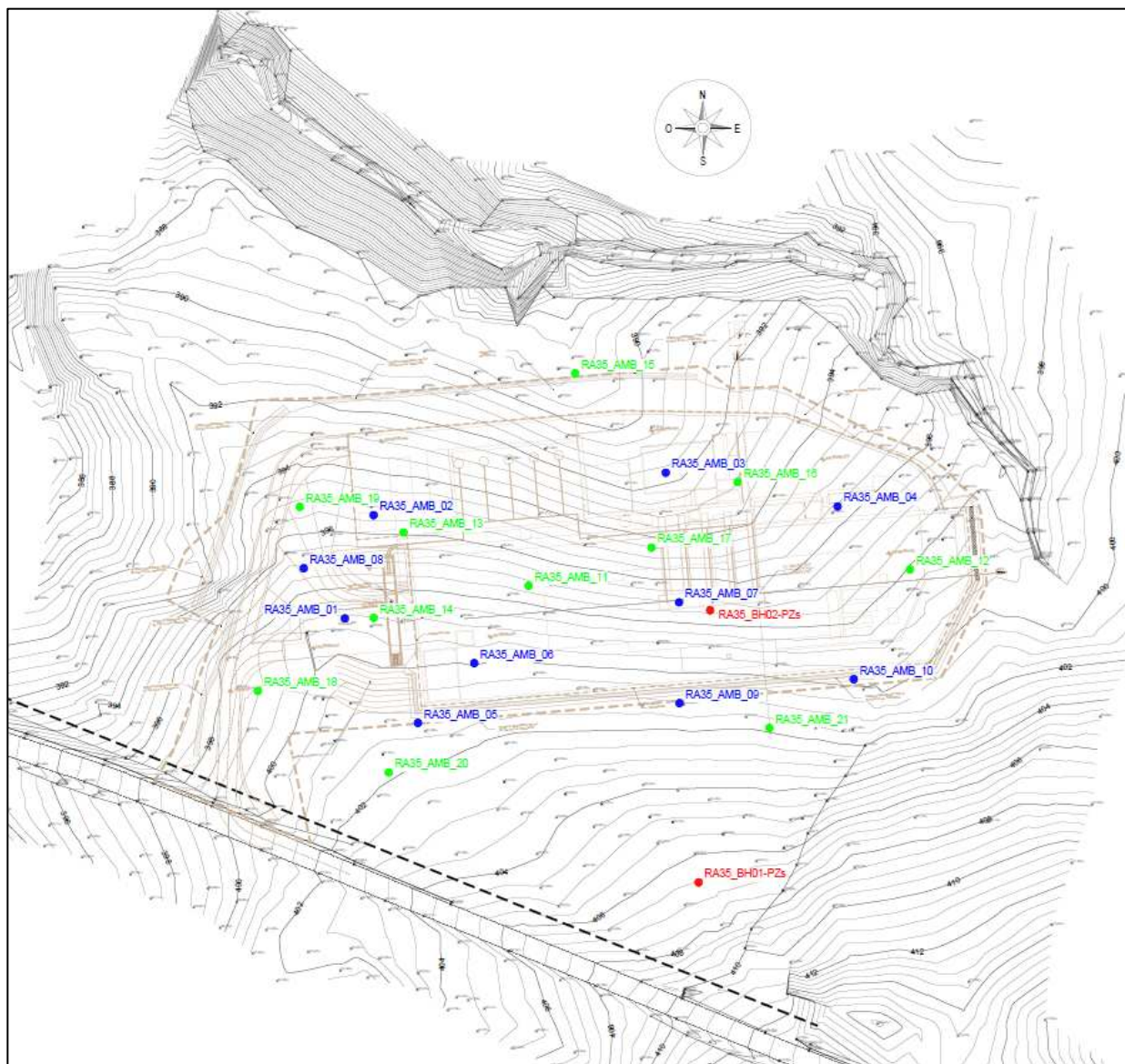
Figura 7-1 Distribuzione dei sondaggi ambientali eseguiti nel sito della postazione: in blu i sondaggi del piano di caratterizzazione, in verde i sondaggi delle indagini integrative per la determinazione dei valori di Fondo Naturale e in rosso i punti di campionamento delle acque.
