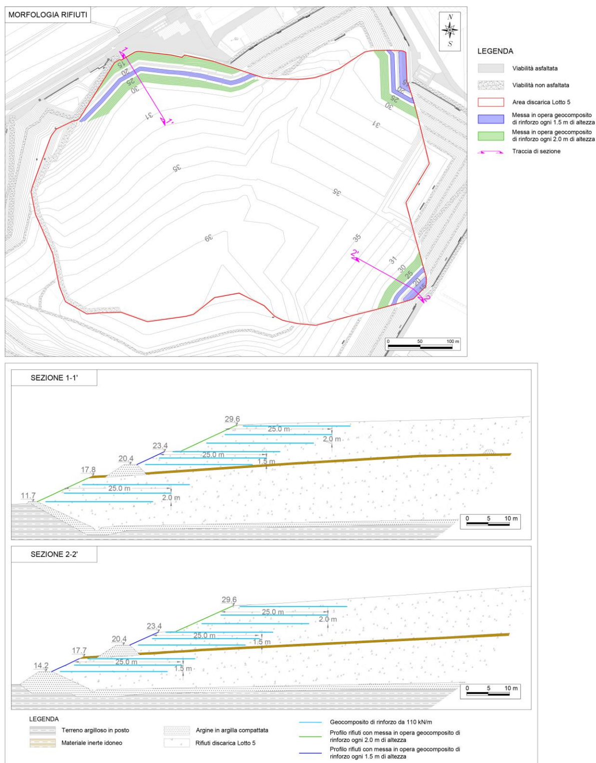
Figura 18:3 – Aree di posa delle geocomposito di rinforzo nei rifiuti e sezioni tipo
