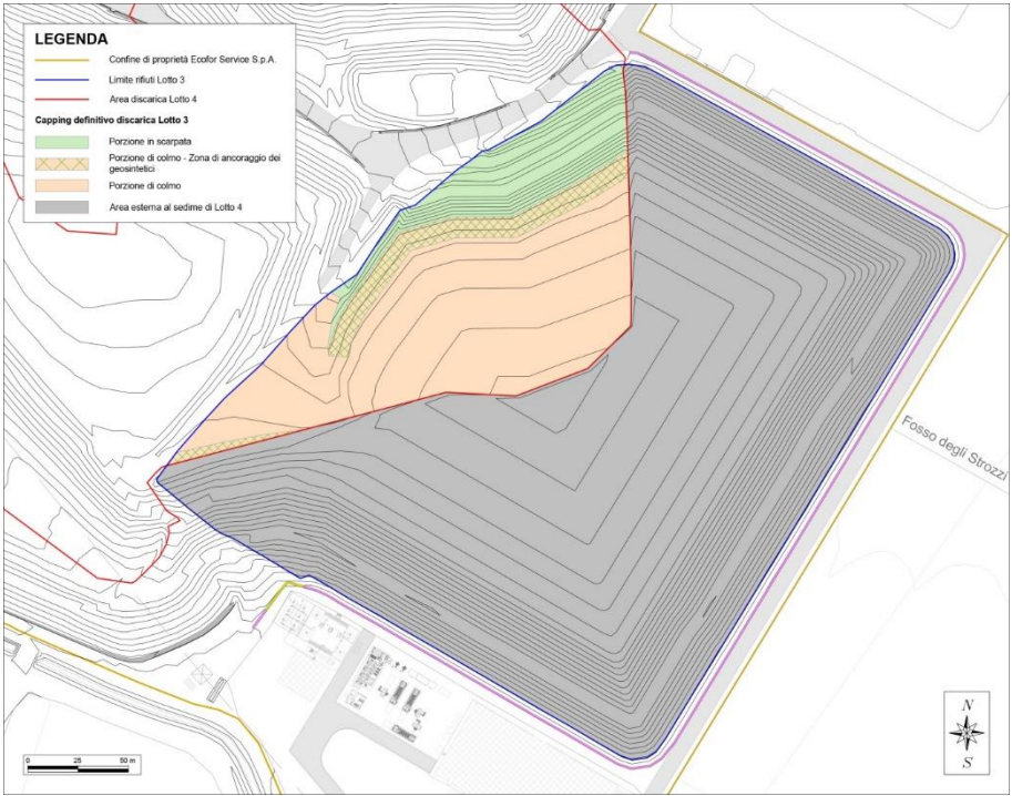
Figura 3:48 – Pacchetto di copertura LOTTO 3 aree interne al sedime del LOTTO 4
