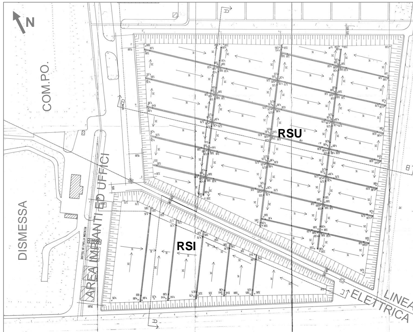
Figura 3:20 – Fondo vasca discarica RSU ed RSI
