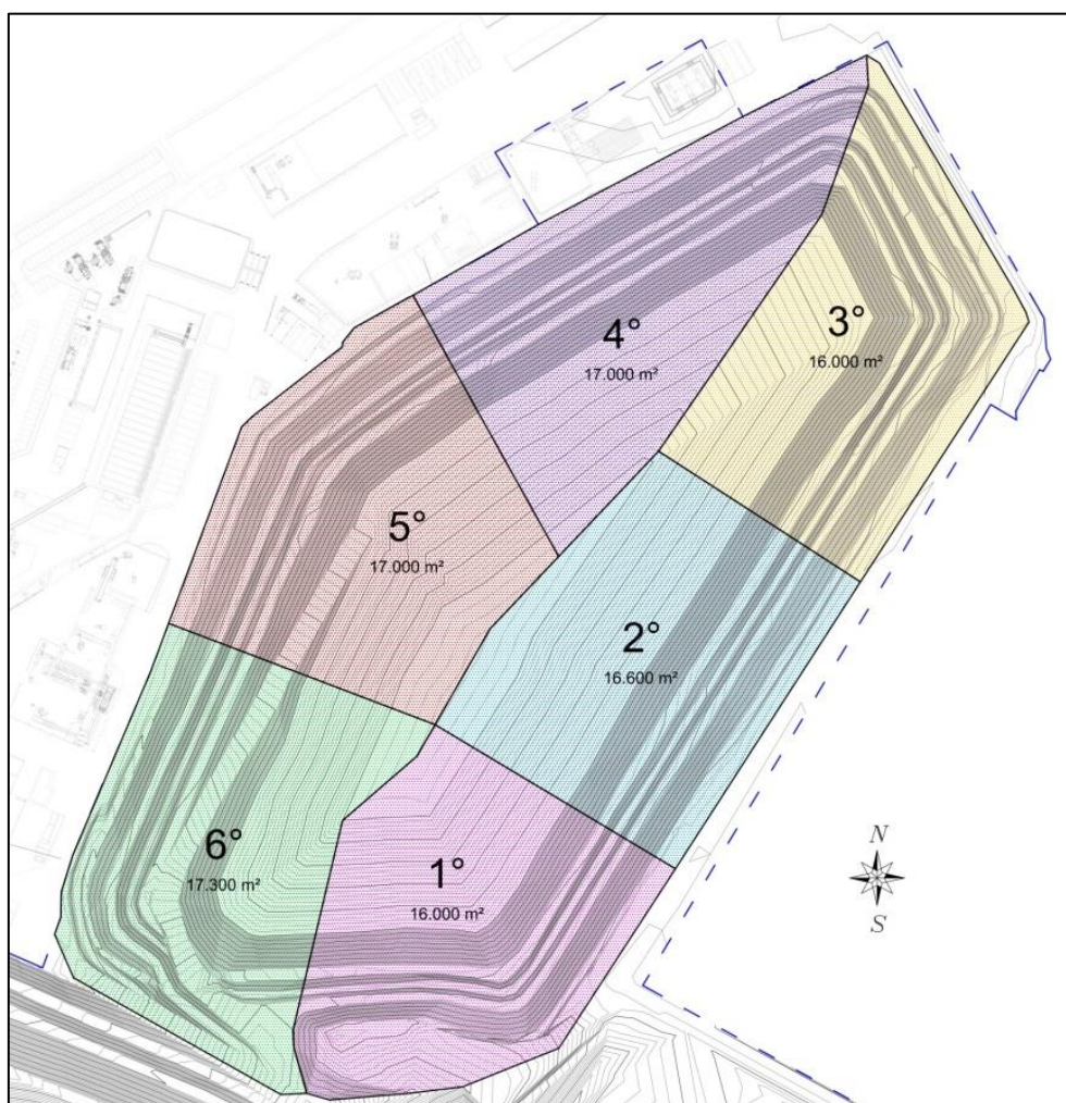
Figura 3:38 – Planimetria suddivisione capping in stralci funzionali discarica LOTTO 2
