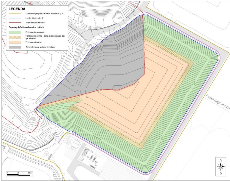
Figura 3:47 – Pacchetto di copertura LOTTO 3 aree esterne al sedime del LOTTO 4
