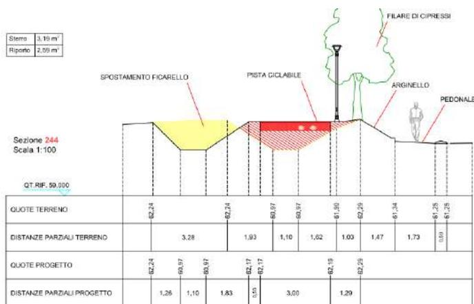
Figura 8 – Assetto di progetto tratto sbocco rotondina – confluenza con MV25368
