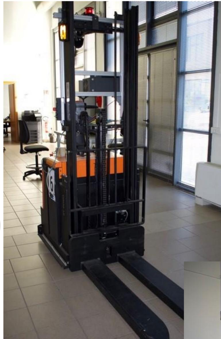
Muletto autonomo per il trasporto automatizzato di pallet in ambiente industriale.
