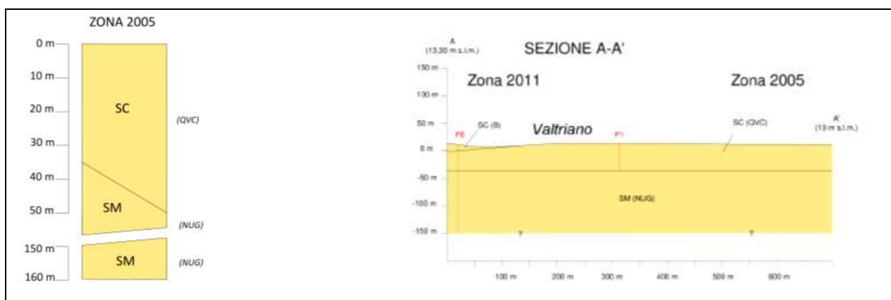
Fig. 9 Colonna Zona MOPS e Sezione geologica – tecnica area di Valtriano
