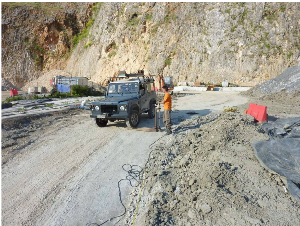
Foto n.9.1 – Fase di energizzazione dello stendimento sismico “Discarica Programma Ambiente Apuana – (onde SH)”
