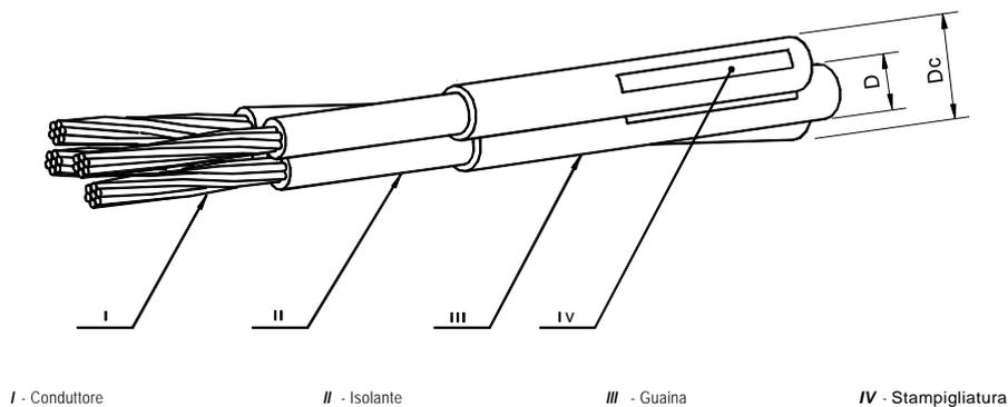
Cavo quadripolare in **alluminio** ad elica visibile
