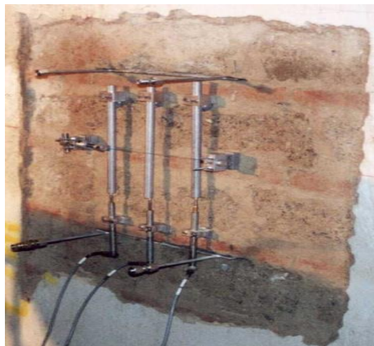
Figura 4: Muratura in masselli e ricorsi con elementi di laterizio (prova 051).
