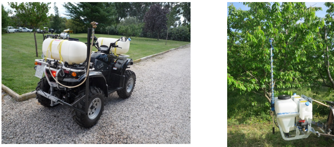
Figura 1. Nuove tecnologie per la distribuzione delle esche proteiche a microdosi
