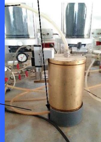
c → valvola di drenaggio per back pressure e misura  $\Delta V$
