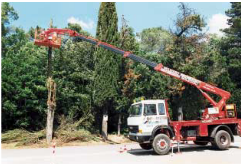
3. Esempi di intervento di abbattimento con piattaforma aerea
