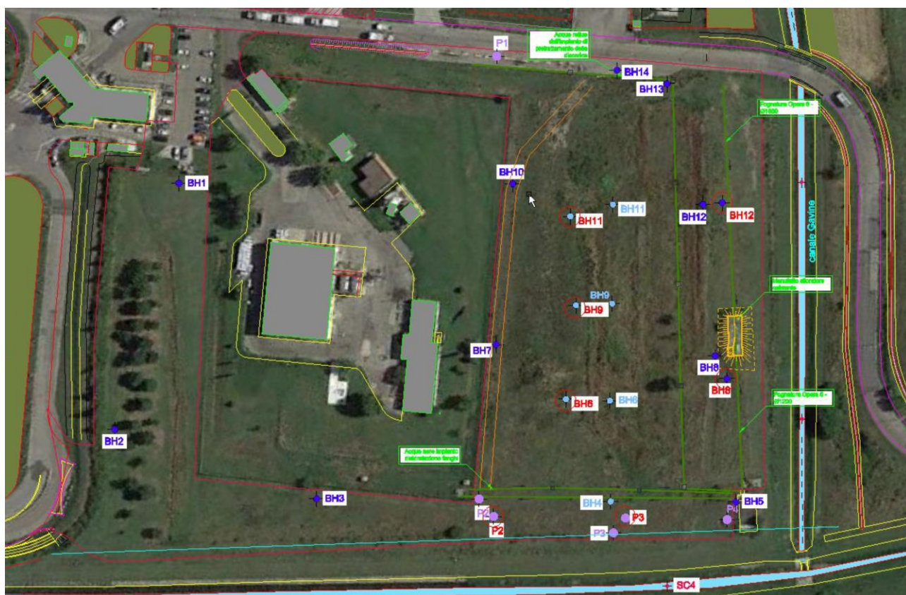
Figura 36 – Planimetria indagini campagna 2016. Rete per il monitoraggio piezometrico P1-P2-P3-P4
