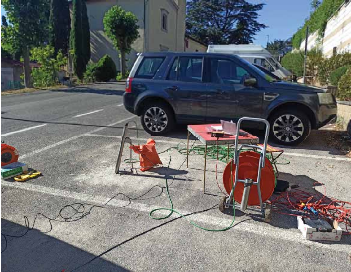
postazione sondaggio– postazione allestimento rilevamento microsismico Down-Hole
