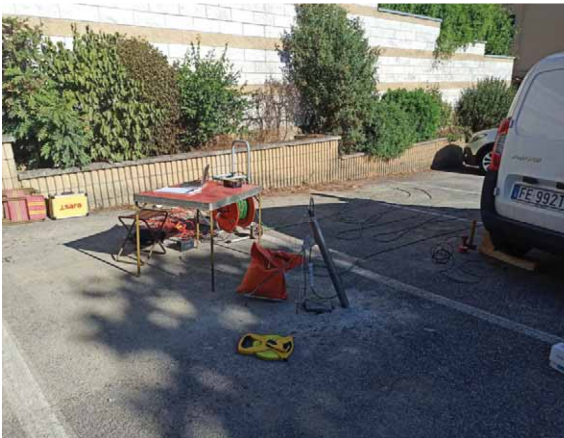
postazione sondaggio– postazione allestimento rilevamento microsismico Down-Hole
