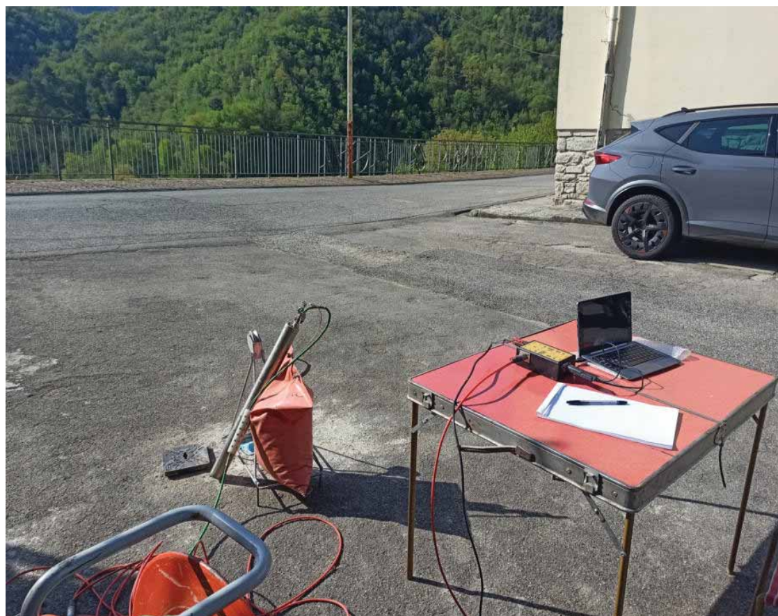
postazione sondaggio– postazione allestimento rilevamento microsismico Down-Hole
