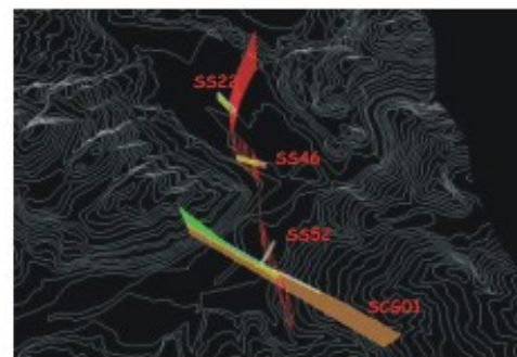
Ricostruzione del piano di faglia, attraverso l'interpretazione dei dati sismici
