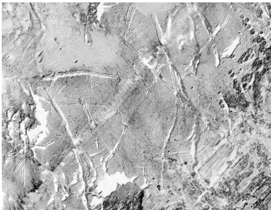
Figura 3.4 – Segni e tracce dell'arare delle ancore delle navi alla fonda sul fondale
