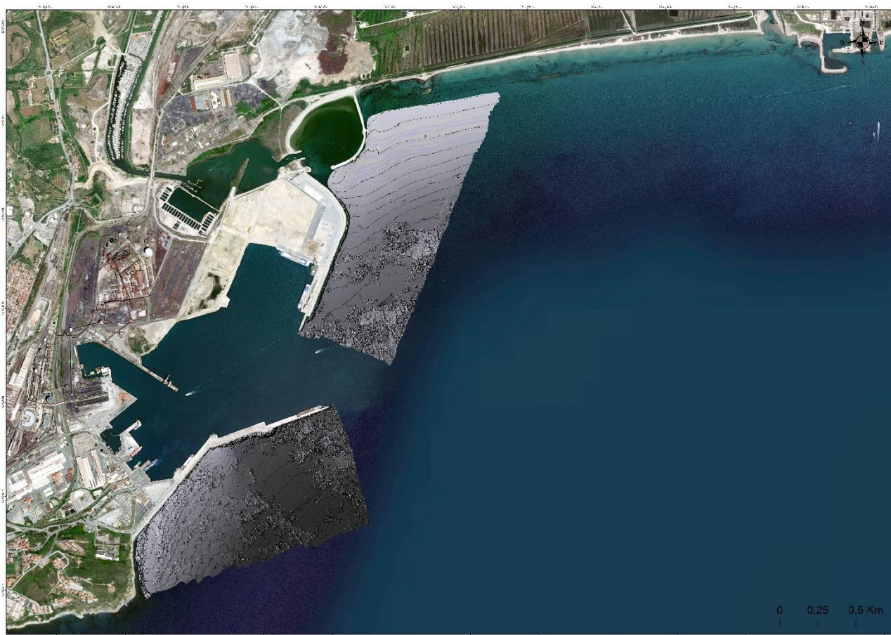
Figura 3-5: Carta del rilievo multibeam effettuato nel mese di maggio 2021
