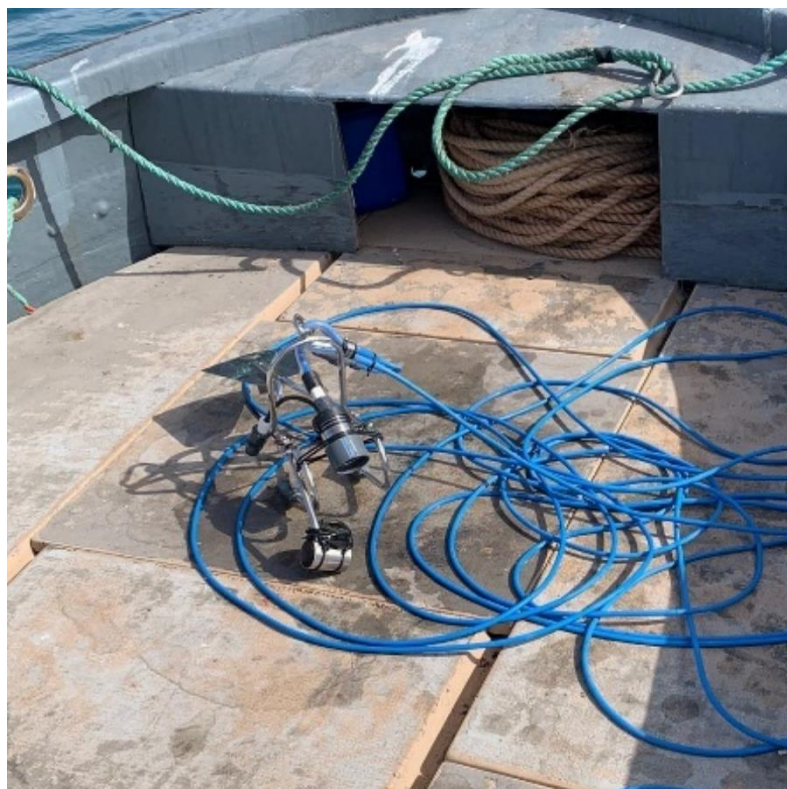
Figura 2.17 – La videocamera trainata utilizzata per il rilievo a Piombino
