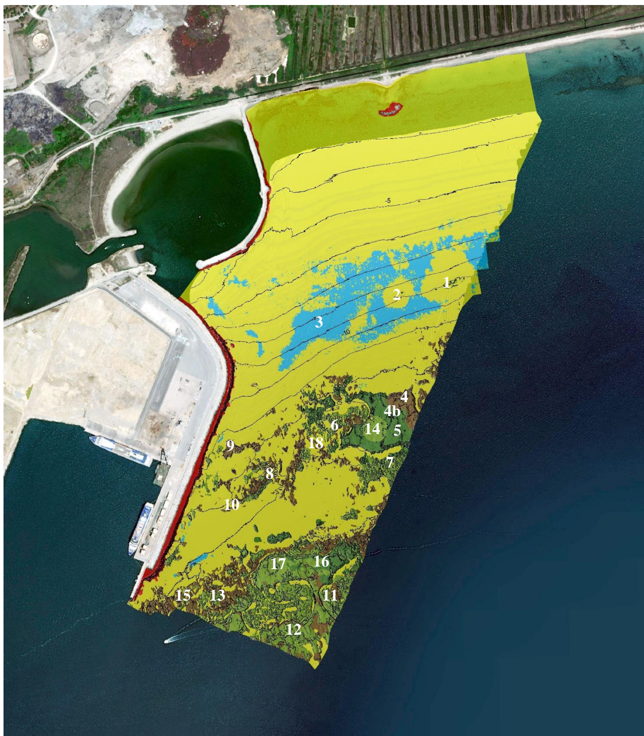
Figura 3.21 – Punti di ispezioni con la videocamera subacquea. I numeri si riferiscono alle immagini successive tratte dai video
