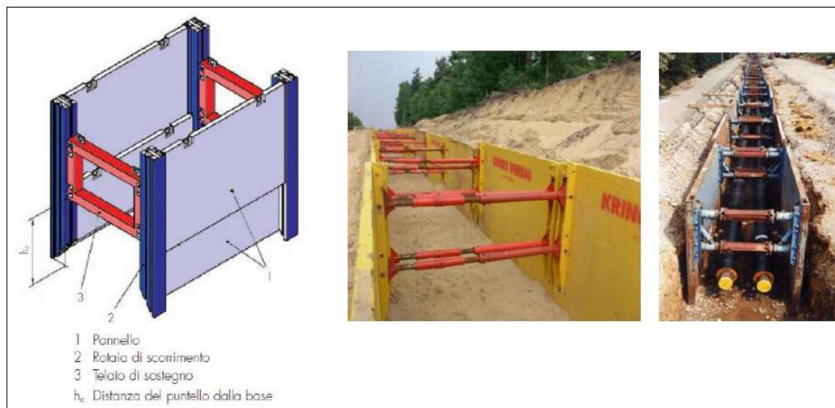
Figura 2-5: Opere provvisorie - sbadacchiature con legname e sistemi di puntellazione per scavi
