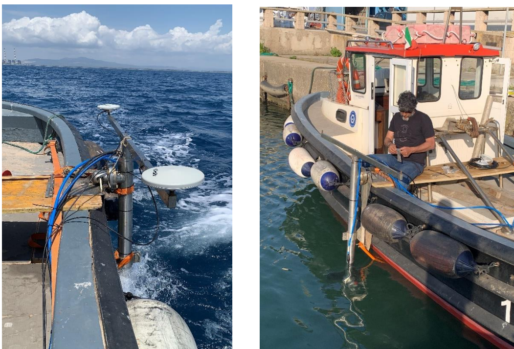
Figura 2-5: Immagini della strumentazione per il Multibeam posizionata a bordo dell'imbarcazione "Ormeggiatore I"
