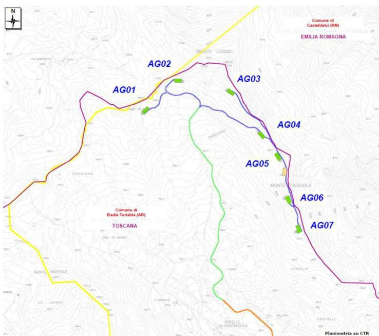
Il nuovo impianto prevede la messa in opera di aerogeneratori tripala di potenza nominale pari a 4.2 MW (29,4 MW di potenza totale). Le sette torri eoliche presenteranno un'altezza pari a circa 112 m al mozzo con un rotore (tripala ad asse orizzontale) di 136 m per una altezza totale complessiva di 180 m.
