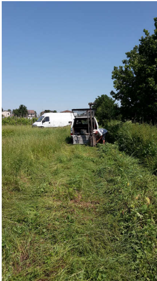
Profilo ST1 – Una fase dell'acquisizione onde P con maglio da 200 kg
