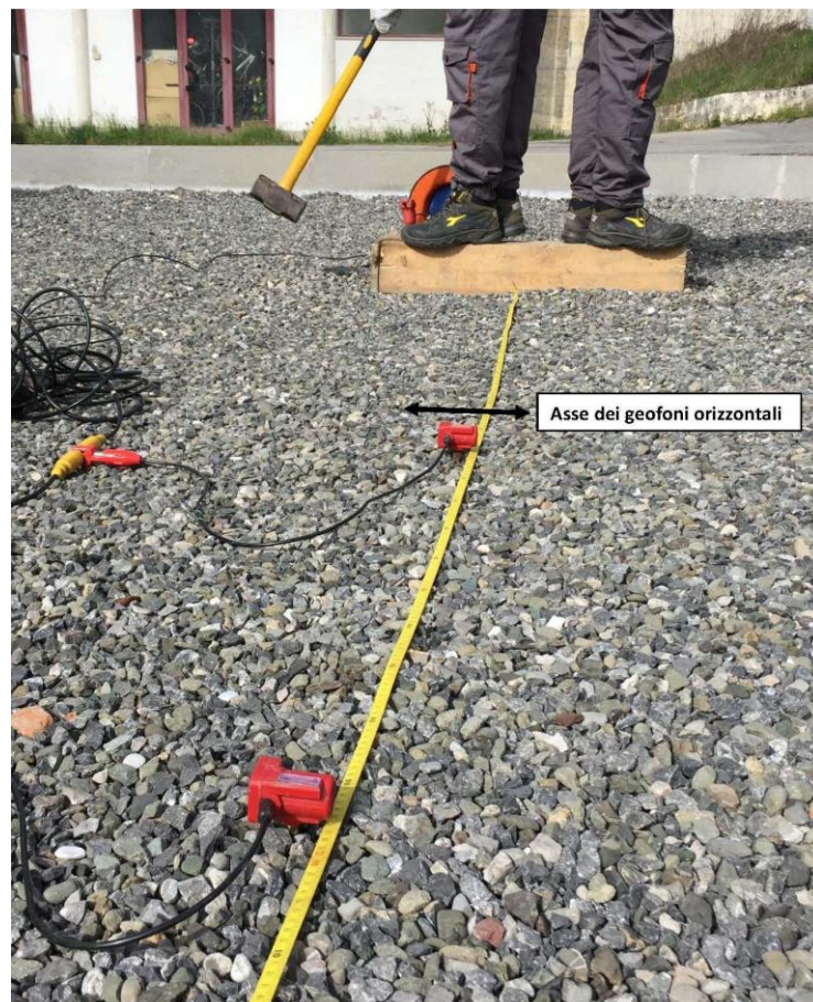
Fig. 8. Sistema di generazione di onde di Love (THF) tramite sorgente di taglio (traversina) ed acquisizione delle stesse per mezzo di geofoni orizzontali disposti con asse perpendicolare allo stendimento.
