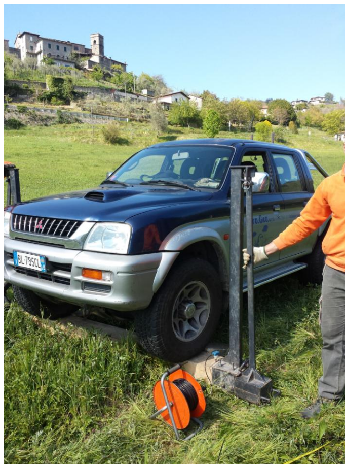
Fig. 3: Sistema di energizzazione per onde trasversali SH (con maglio da 30 kg)
