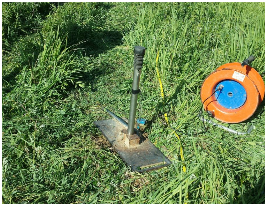
Fig. 2: Cannoncino industriale (calibro 8) per la generazione delle onde longitudinali P
