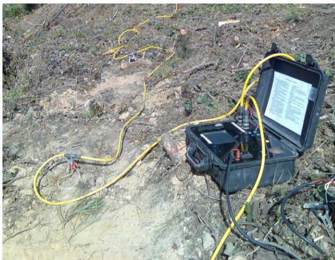
Fig. 9. Georesistivimetro utilizzato per l'acquisizione dei dati (EEG AL48D)
