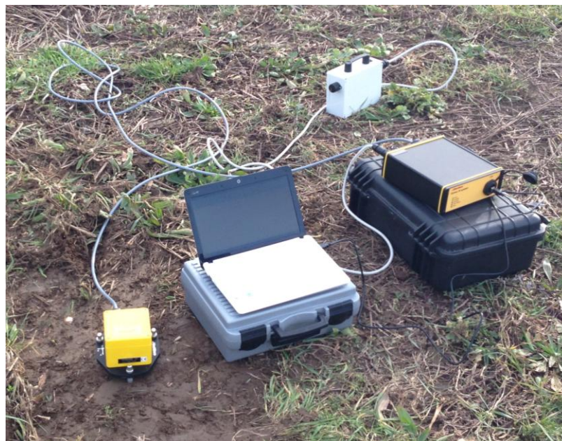
Fig. 11. Sistema di acquisizione "Dymas-24" collegato a PC portatile e sismometro "Veloget3D" per misure di rumore ambientale a stazione singola (metodo HVSR)
