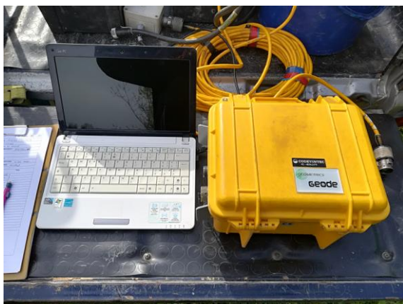
Fig. 1. Sismografo GEOMETRICS GEODE
