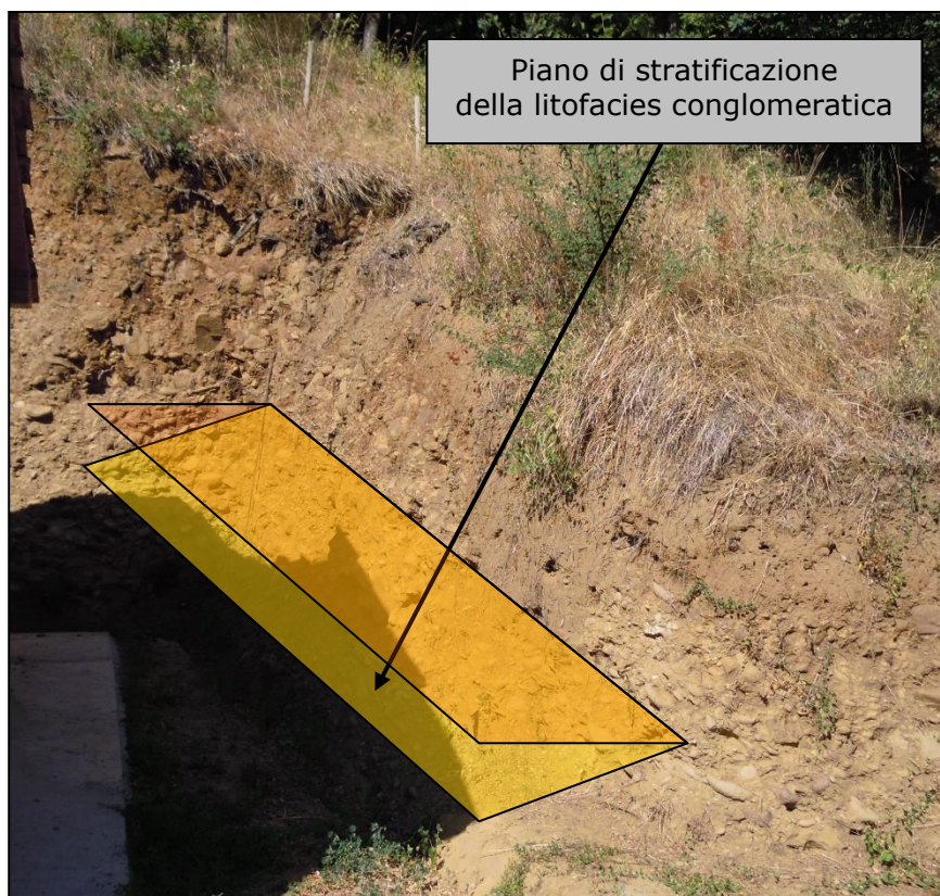
Fig. 9 – Piano di stratificazione rilevato all'interno della litofacies conglomeratica.
