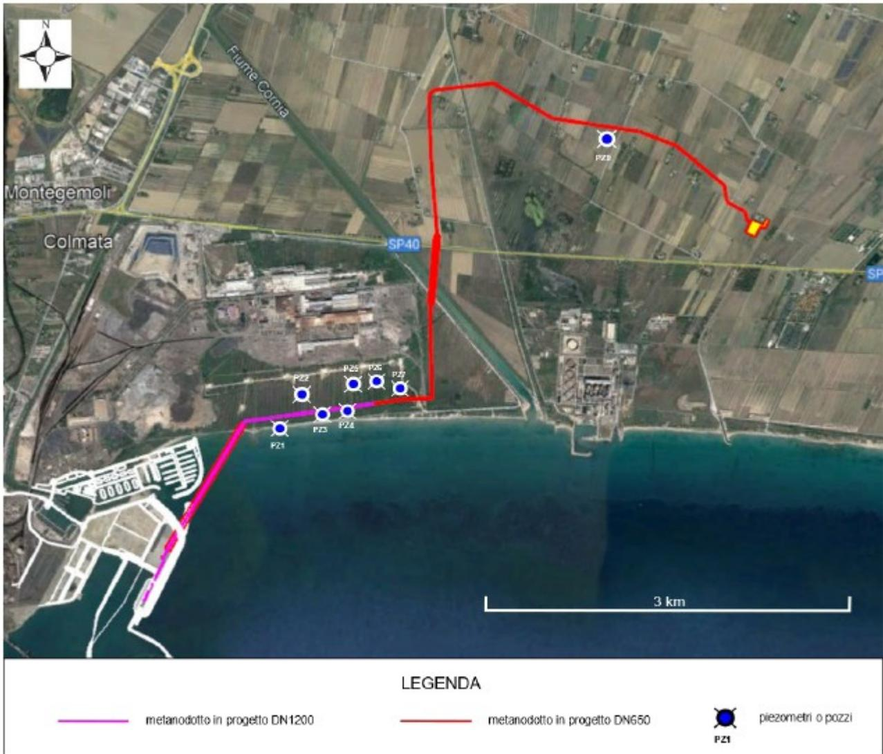
Figura 3 – Disposizione dei piezometri e del pozzo censiti lungo il tracciato del metanodotto (Fonte: Relazione idrogeologica e censimento punti d’acqua lungo il tracciato – REL-CI-E-00002)
