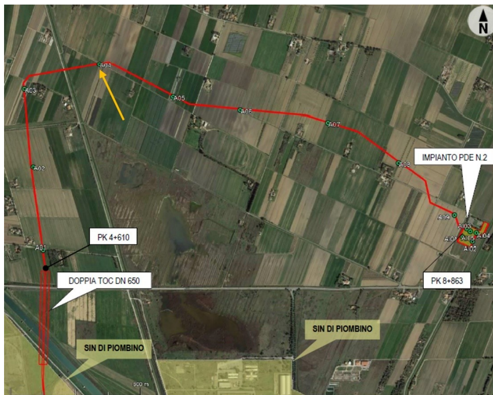
Figura 3 Tracciato di progetto esterno al SIN e impianto PDE n.2 oggetto di caratterizzazione TRS. La freccia gialla indica il punto di prelievo A04 in cui si sono riscontrati i due superamenti della CSC relativa al Mercurio (Fonte: REL-PDU-E-00002; Elaborazione: TERRA SRL).
