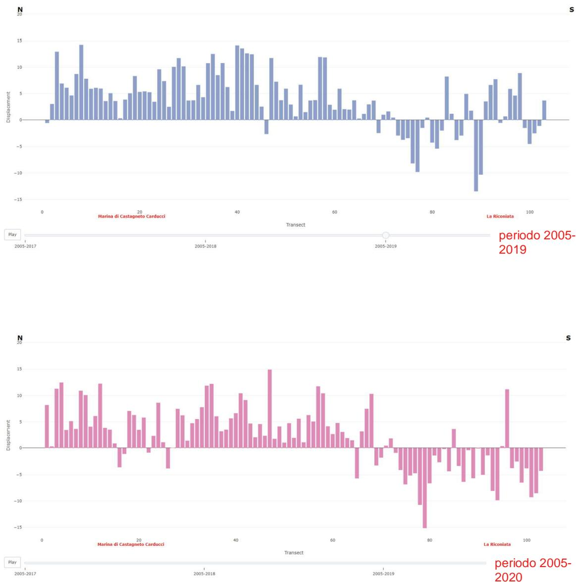
**Fig. 25 Dettaglio dell'andamento degli scostamenti annuali in metri della linea di riva lungo i transetti con spaziatura 50 m del settore 25 (da Marina di castagneto Carducci a La Riconiata).**
