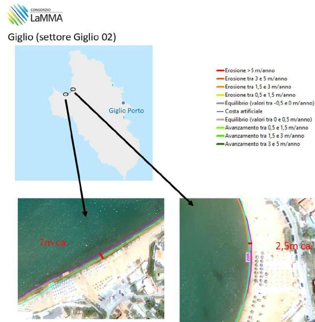
Fig. 13 Dettaglio dell'andamento della linea di riva nei settori del Giglio.
