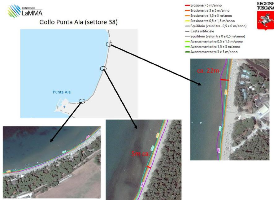
Fig.5 Dettaglio dell'andamento della linea di riva nei settori 37 e 38. In fucsia la linea di riva del 2005, in verde il 2019 e in giallo il 2020.
