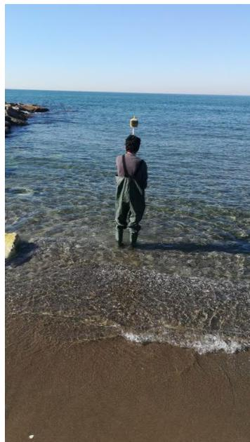
**Fig. 15 Un momento dell'attività di rilievo dGPS della linea di riva e della spiaggia sommersa sino alla profondità di ca -1m**
