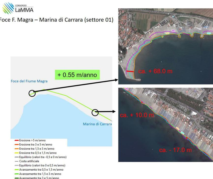
**Fig.3 Dettaglio dell'andamento della linea di riva nel settore 01.**
