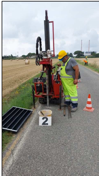
Foto n 1 - sonda oleodinamica Hydra-Drill DR M50/60
