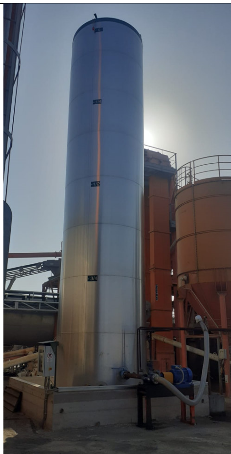
Foto 8 - Serbatoio BTZ (51 mc)
