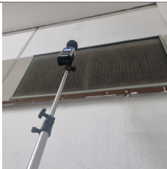
Rilievo interno in locale convertitore di fronte prese aria
