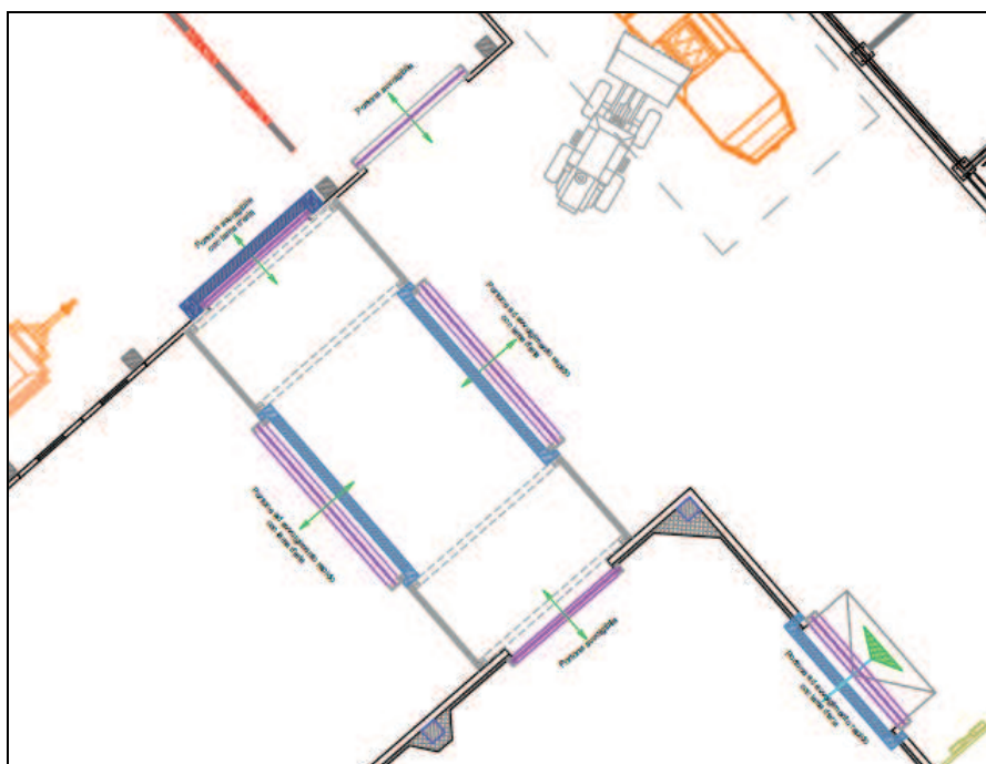
Figura 12 Bussola di collegamento con lame d'aria
