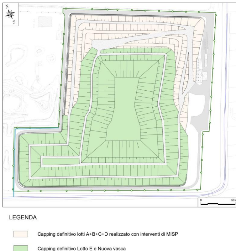
Figura 3:4 – Suddivisione interventi di capping definitivo
