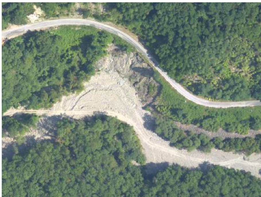
Figura 1.29 – (O) Erosione in curva presso la sezione n. 71 con pericoloso avanzamento verso la SP 69
