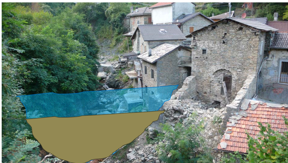
Figura 2. 5- Canale del Bosco: sezione in cui è stata ipotizzata l'ostruzione (FOTO 30 in planimetria TGL 1.2)
