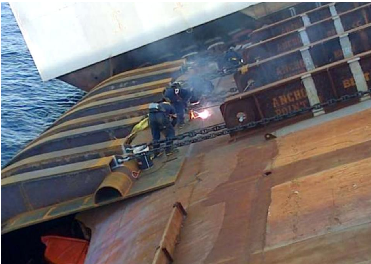
Sopra: Operazioni di saldatura della Gash Plate installata sulla falla per agevolare il passaggio delle catene Sotto: Pali DH10 e DH12 a Piombino pronti per essere trasportati in area di lavoro
