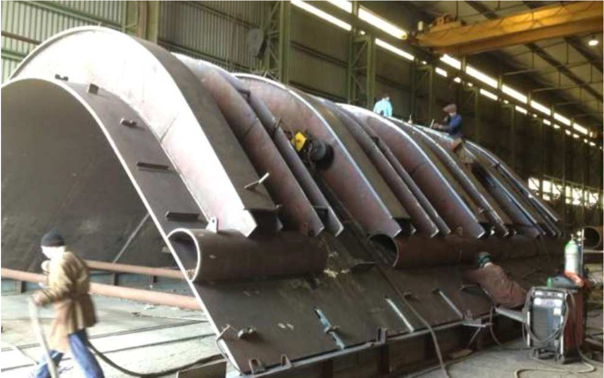
Gash Plate pronta per essera trasportata in area di lavoro ed installata sulla carena in prossimità della falla
