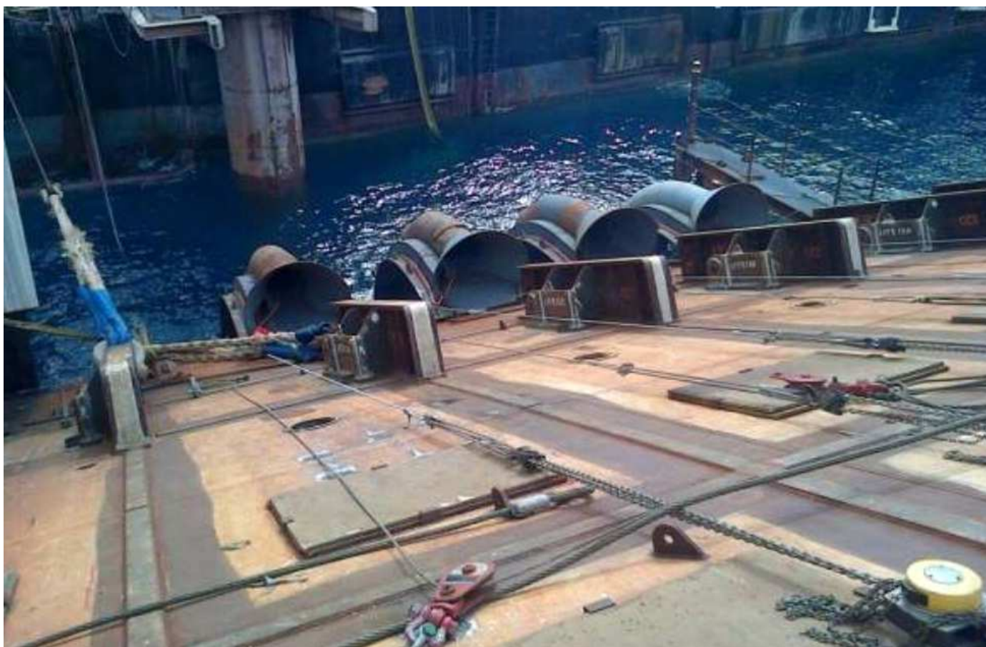
Installazione dei rinforzi della carena di dritta (bilge plates)
