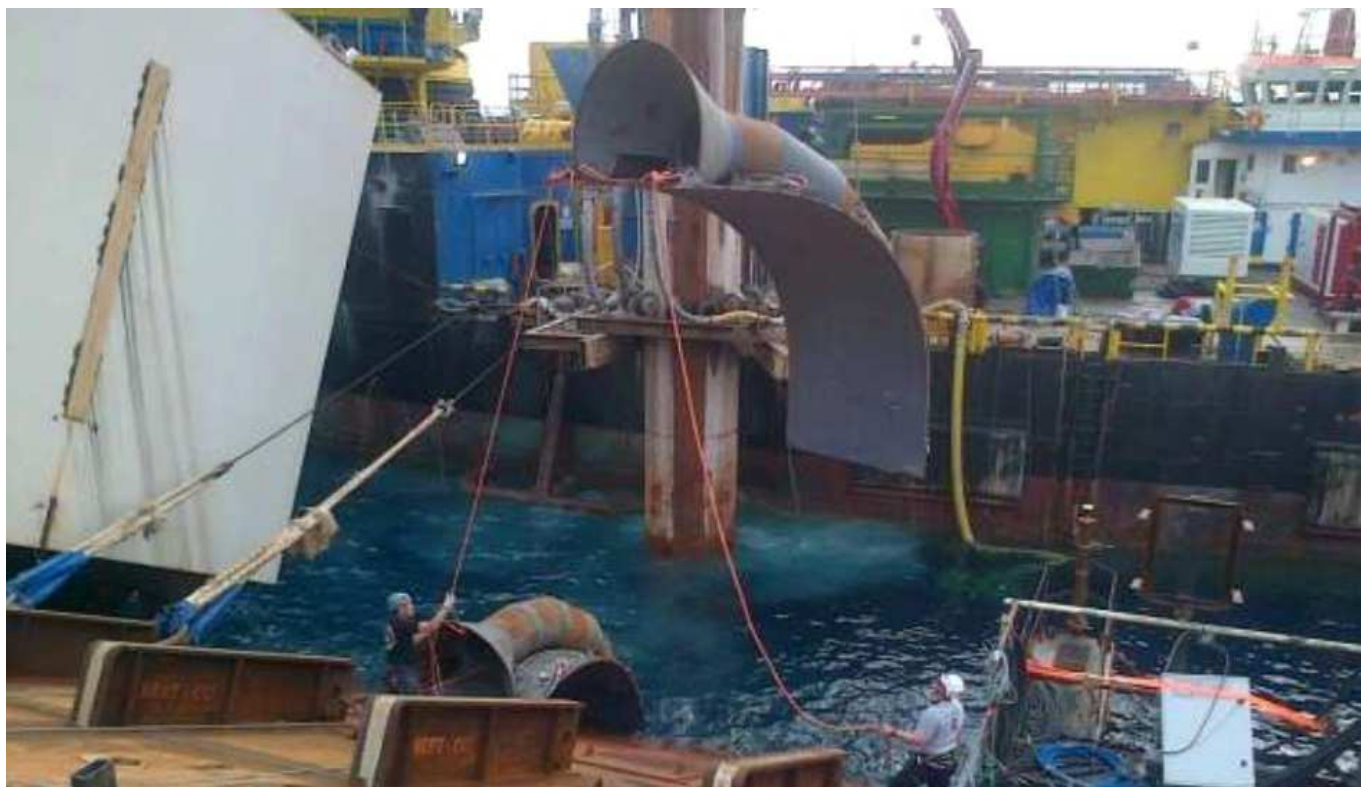
Installazione dei rinforzi della carena di dritta (bilge plates)
