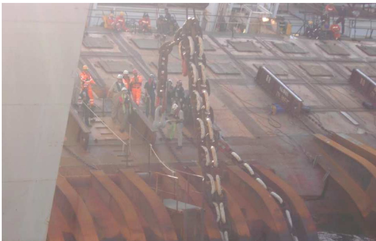
Installazione seconda gash Plate sulla falla per posizionamento catene per sistema di ritenuta
