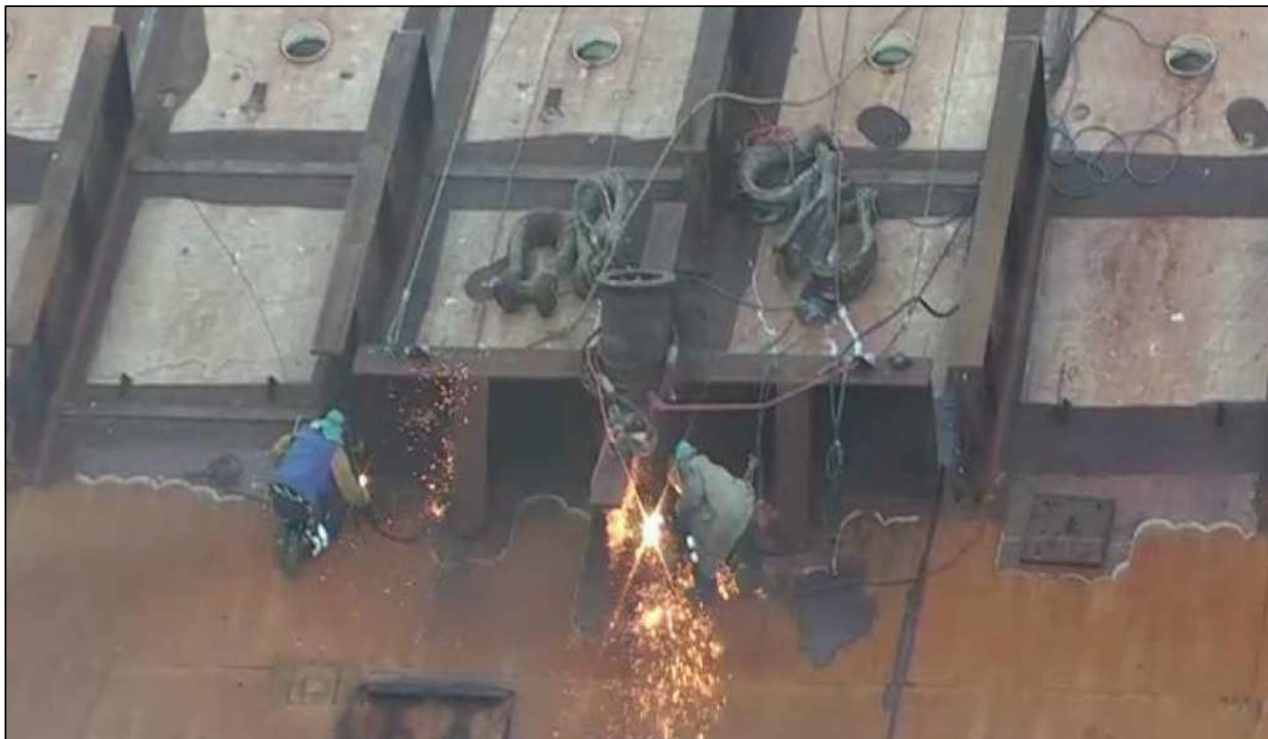
Sopra: operazioni di rimozione bitte sulla Costa Concordia
