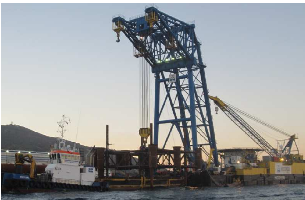
Sopra: Dima sul pontone Micourier 1. Sotto: operazioni di posizionamento dima sul fondale
